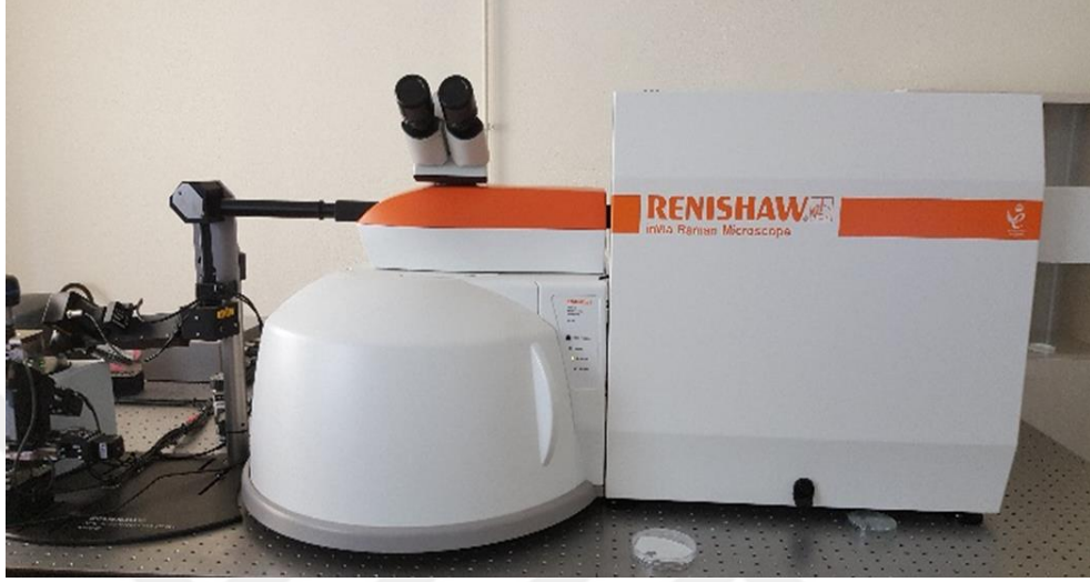
Fotoğraf 3.1. Grafen karakterizasyon işlemlerinin gerçekleştirildiği Raman spektroskopisi cihazı
