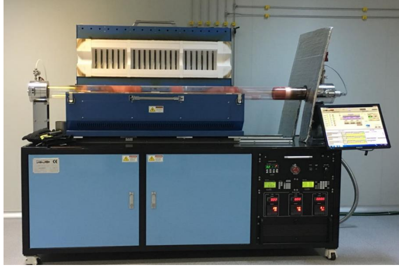
Fotoğraf 3.3. Grafen sentezi için kullanılan CVD sistemi
