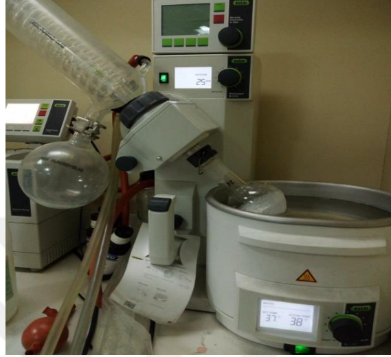
Resim 3.5. Geri çeviren soğutucu (Evaporatör).
