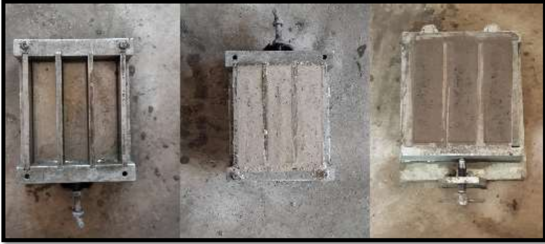
Fotoğraf 4.6 Harç karışımlarının kalıplarına yerleştirilmiş hali
