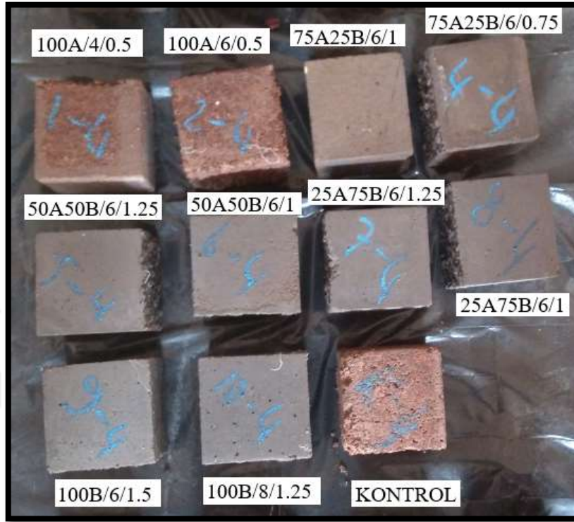
Fotoęraf 4.14 Asit etkisinde kalan betonların grnmleri
