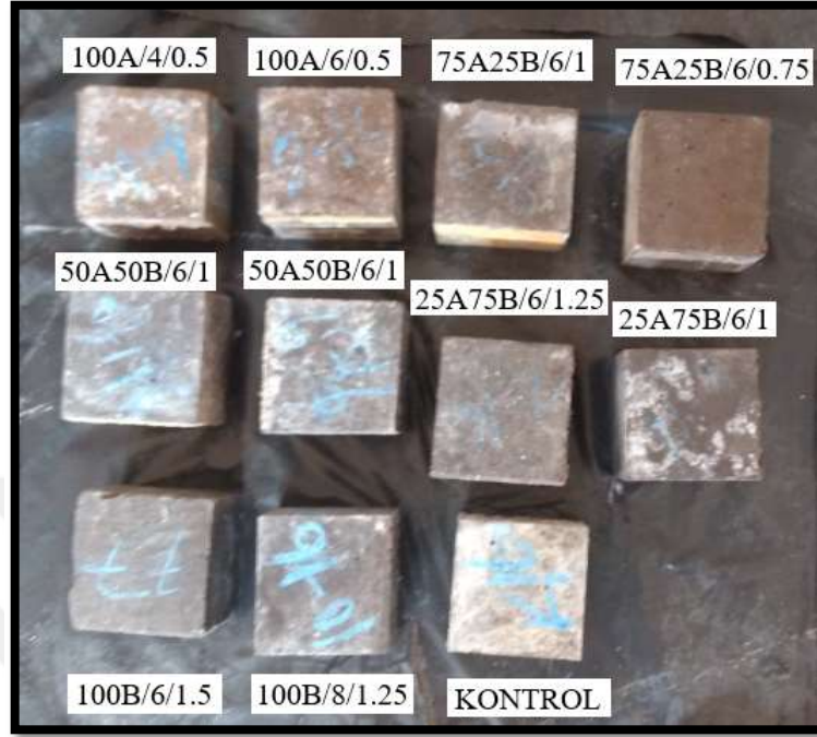
Fotoğraf 4.15 Sülfat etkisinde kalan betonların görünüşleri
