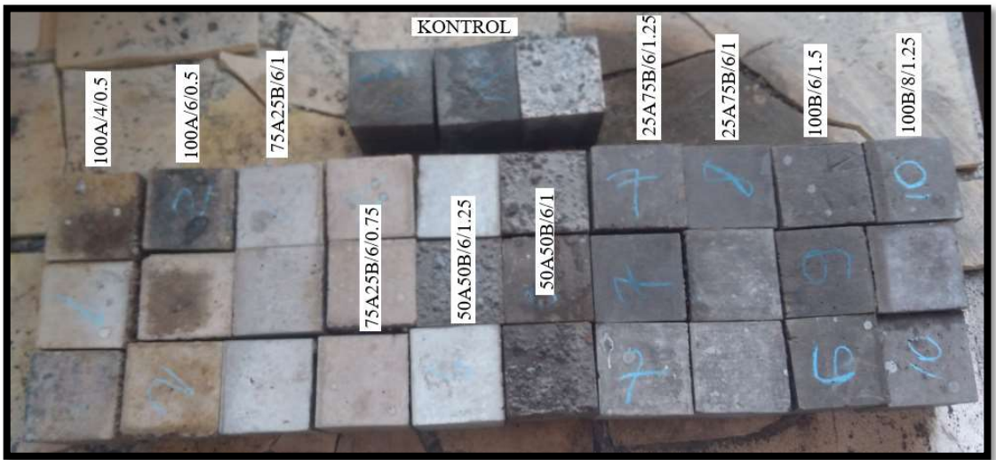
Fotoğraf 4.17 Yüksek sıcaklık etkisinde kalan betonların görünümüleri
