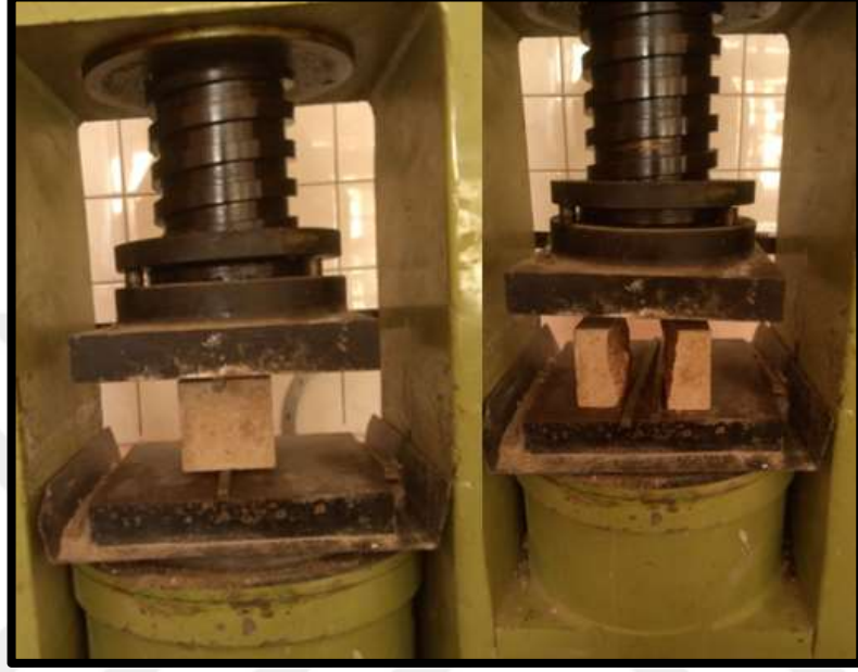
Fotoğraf 4.13 Betonların yarmada çekme dayanımlarının belirlenmesi
