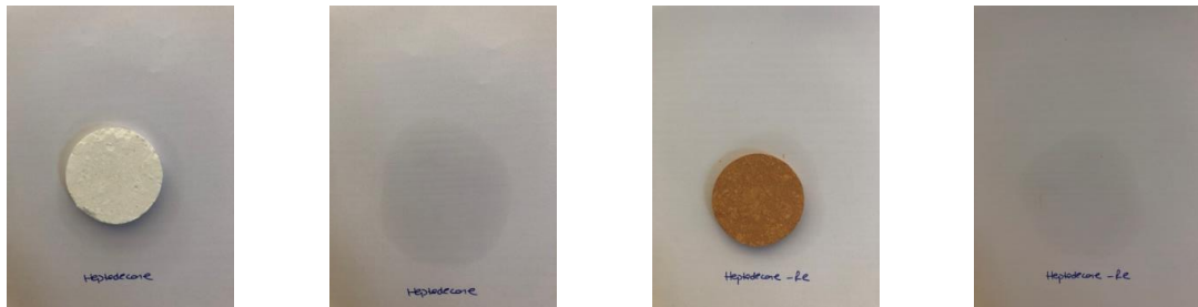
Fotoğraf 4.6. Heptadekan mikrokapsülleri mekanik dayanım testi sonuçları(MF'li-RMF'li)
