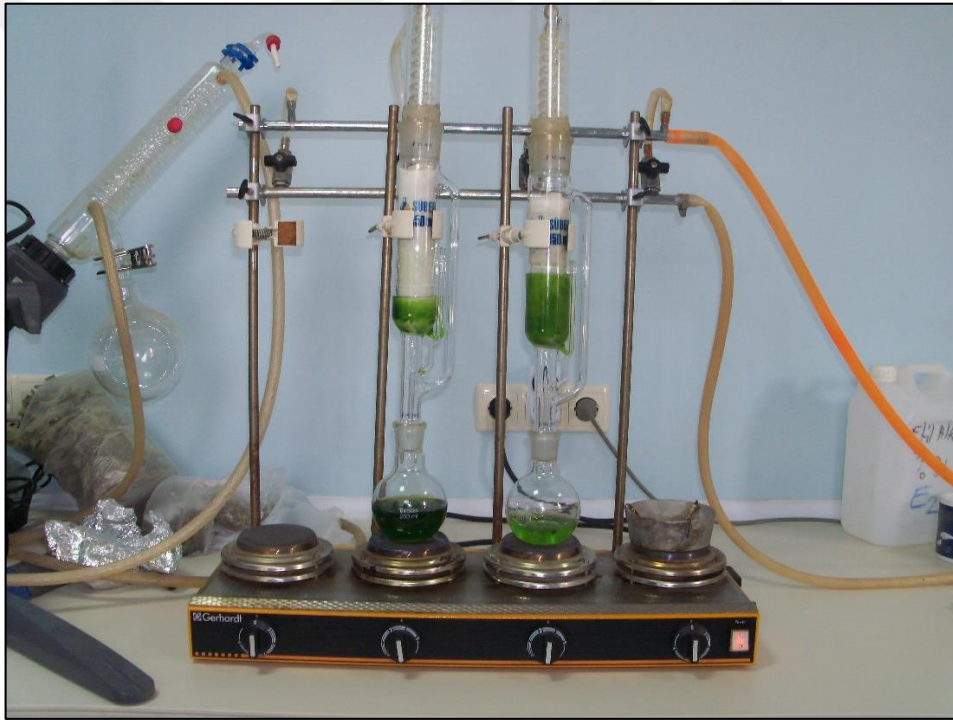
Şekil 3.3. Bitki örneklerinin soxhlet ekstraksiyonu genel görünümü
