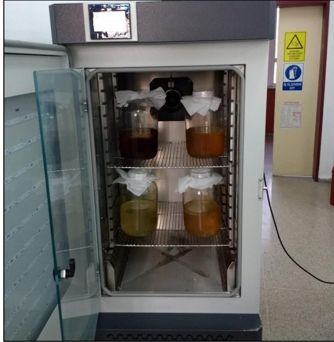
Şekil 3.3. Örneklerin iklim dolabında fermantasyona bırakılması
