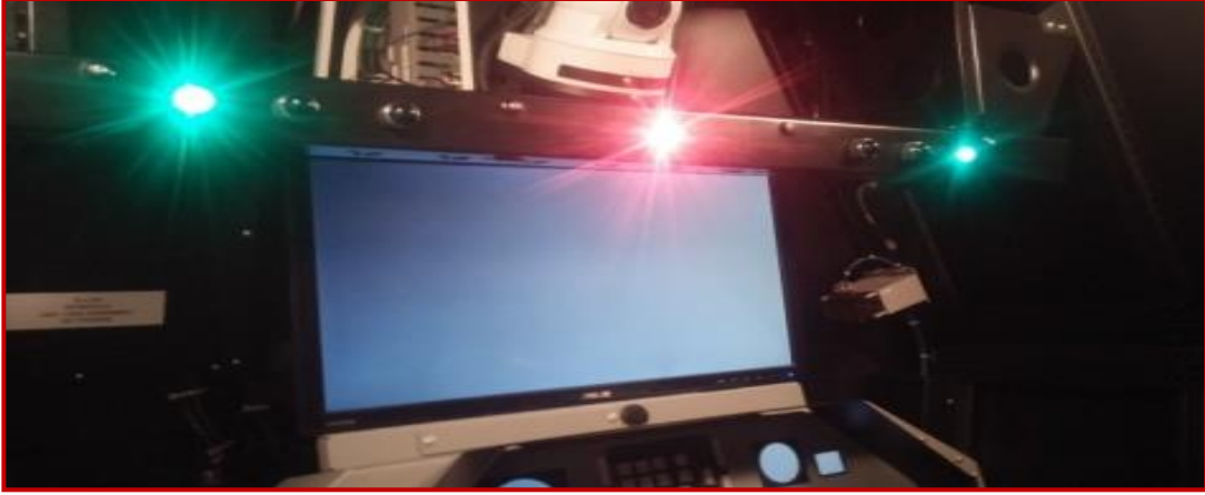
Şekil 2.14. İnsan santrifüjü cihazında periferik görüşü test eden ışıklı bar
