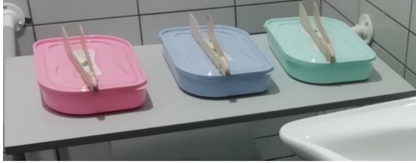
Şekil 3.5. Karanlık oda içerisinde film eldesi (pembe kapta developer solüsyonu, mavi kapta fixer solüsyonu, yeşil kapta ise ddH 2 O bulunmaktadır)
