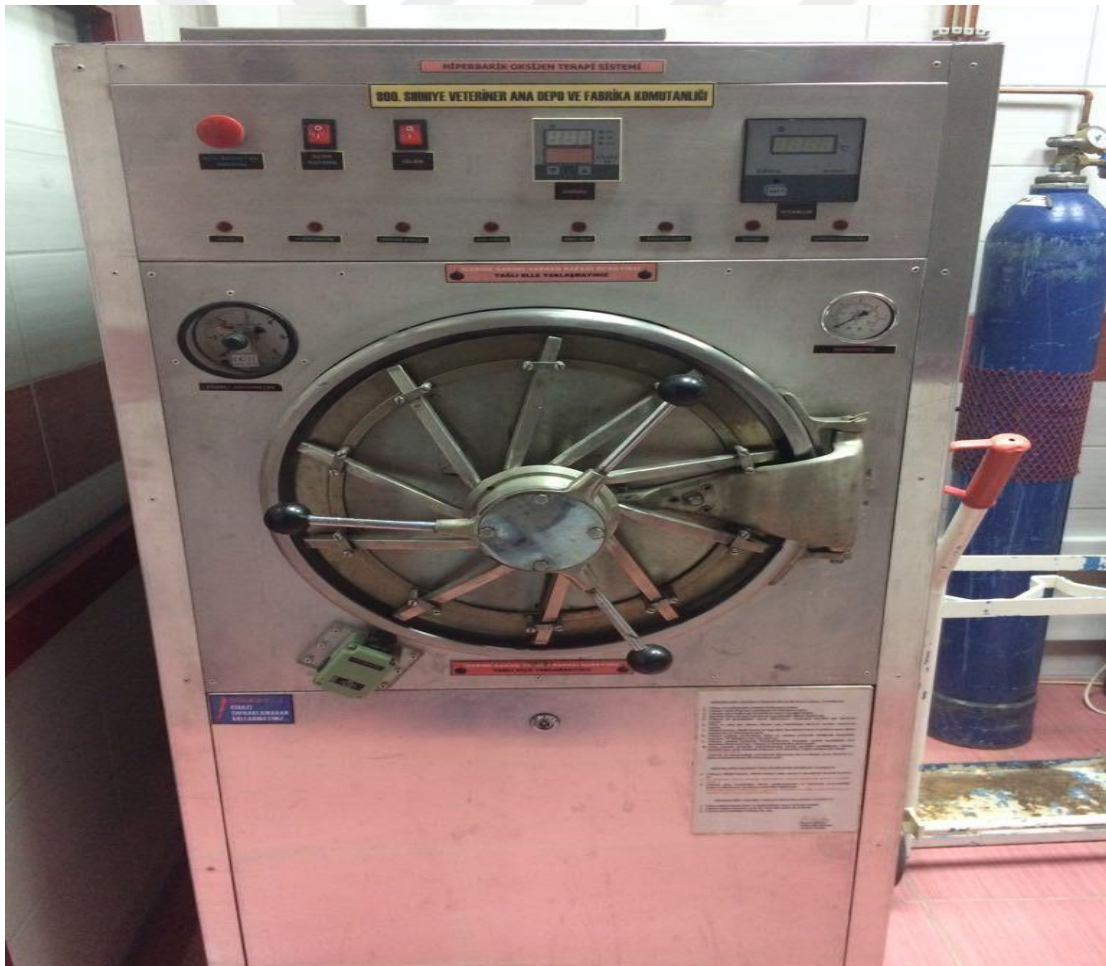
Şekil 3.1. Gülhane Tıp Fakültesi Fizyoloji Anabilim Dalı'nda bulunan deneysel basınç odası
