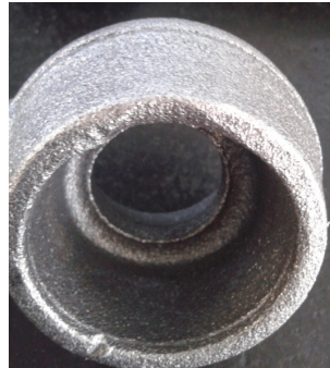
Fotoğraf 1.1. Kalıbı doldurmama hatasının parçadaki görünümü
