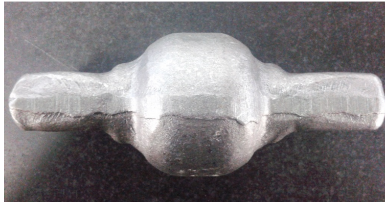
Fotoğraf 1.5. Parçadaki çapak fazlalığı
