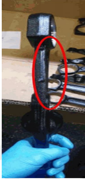
Fotoğraf 2.3. Süspansiyon parçasında meydana gelen eğilme hatası
