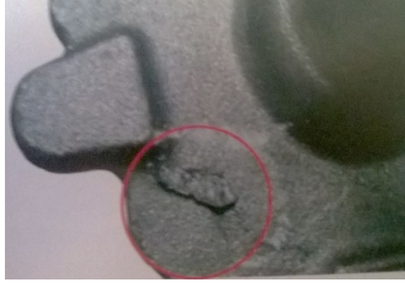
Fotoğraf 1.9. Sıvanma yüzey hatası
