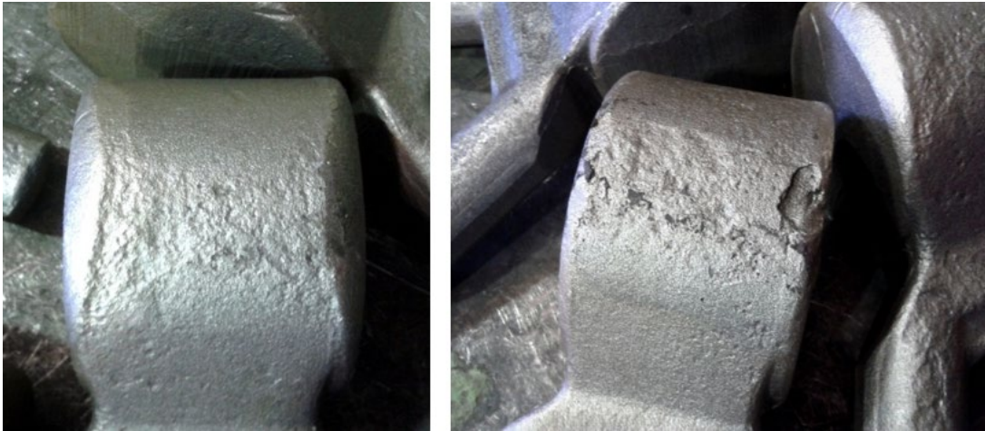
Fotoğraf 1.8. Tufalin temizlenmeden dövme yapılması sonucu oluşan kötü yüzey
