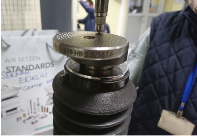
Fotoğraf 2.12. Numunelerin sertlik ölçme işlemi
