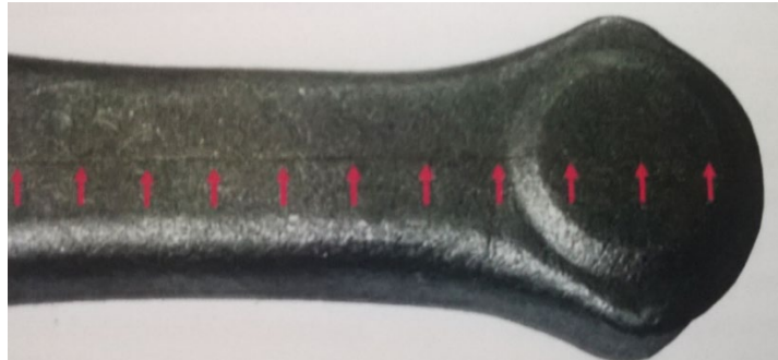
Fotoğraf 1.14 Yüzeyde görülen çatlak hatası
