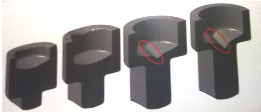
Fotoğraf 1.2. İçe çekme hatasının şekillenme sonuna doğru oluşumu
