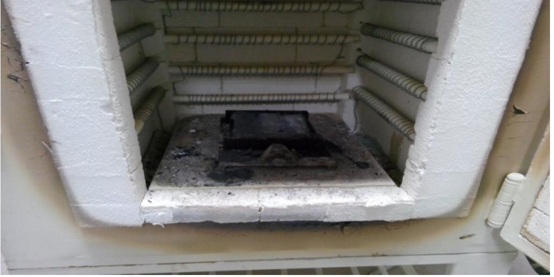
Fotoğraf 3.5. Geopolimer yapı malzemelerinin kürlendiği kül fırını
