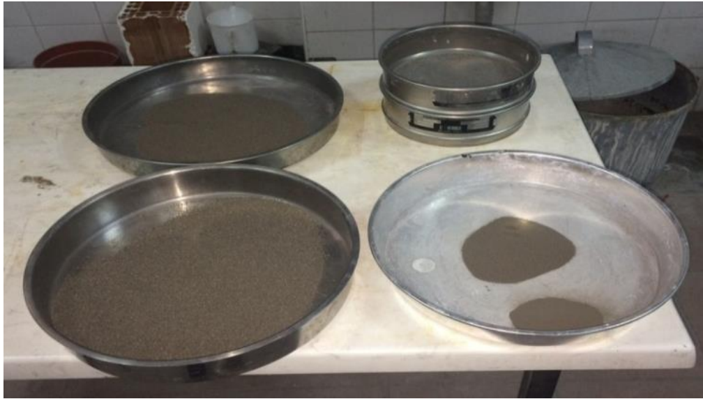
Fotoğraf 3.3. ADK'nın laboratuvarında elek analizi
