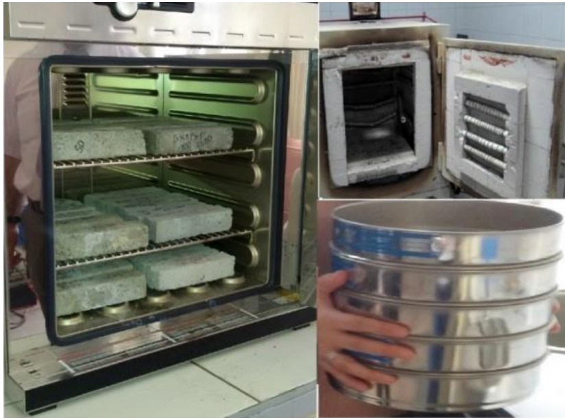
Fotoğraf 3.2. a) Etöv, b) Kül fırını ve c) Elek serisi
