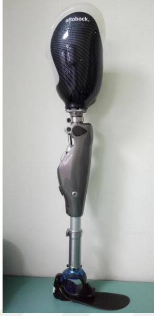
Şekil 2.8. Diz eklemi mikroişlemci kontrollü diz üstü protez
