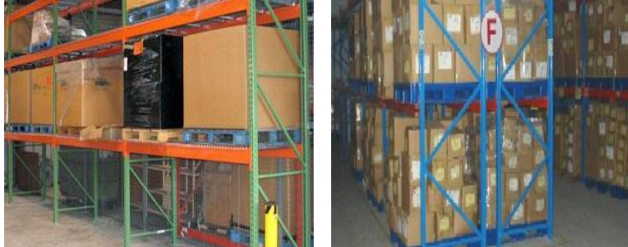
Şekil 2.11 Tek ve çift taraf palet rafı 15
