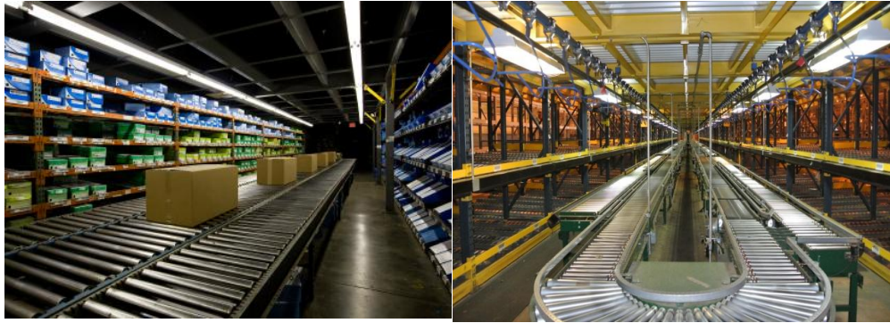
Şekil 2.19 Depolarda konveyör sistemleri 24
