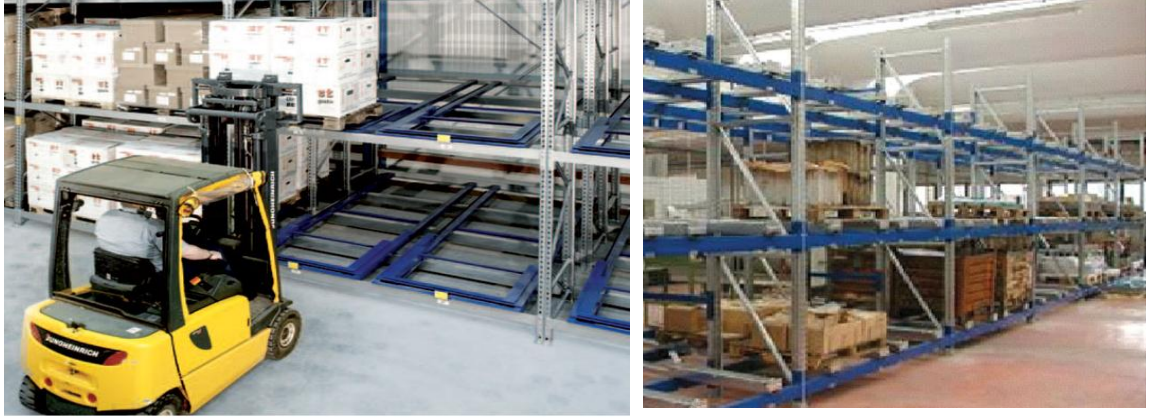
Şekil 2.13 Kayar ve geri itmeli raf sistemleri 18
