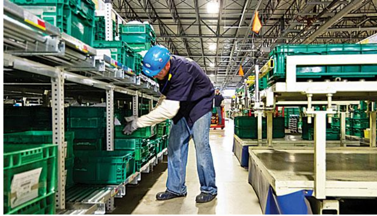
Şekil 3.6 Toplayıcının parçaya gittiği sipariş toplama sistemi 27
