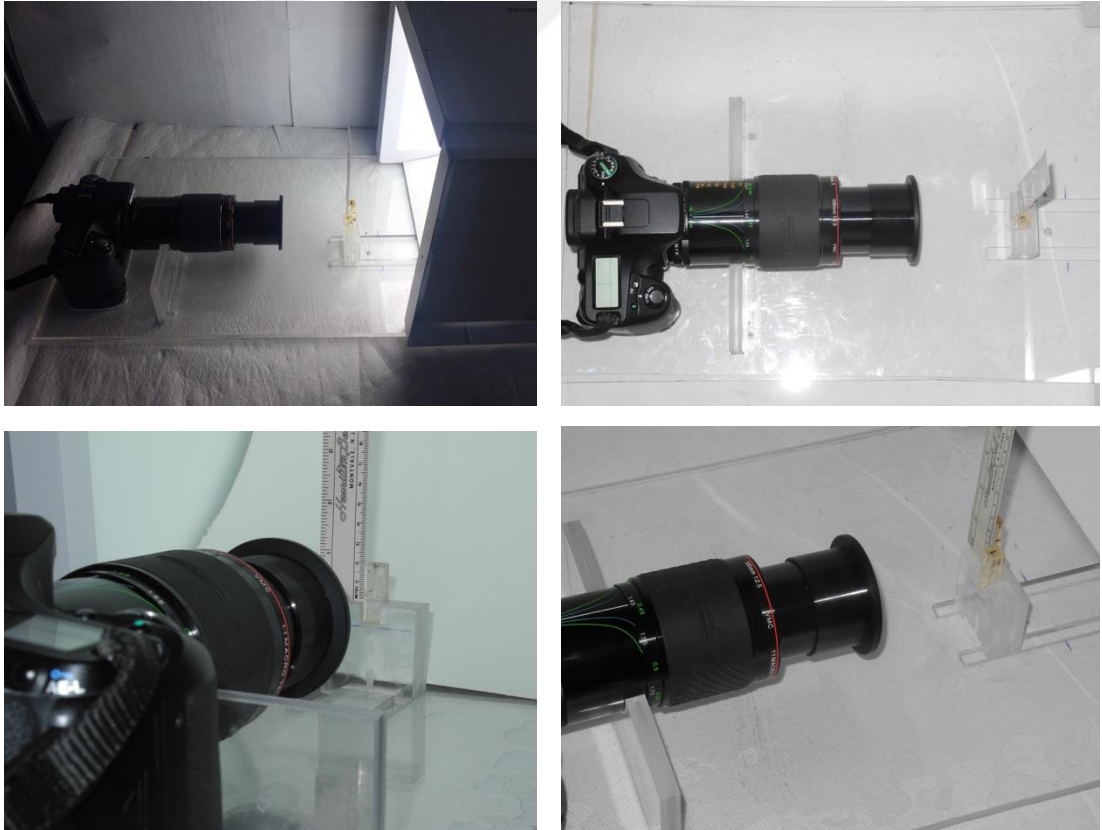
Şekil 3.3. Şekillendirme deneyi için hazırlanan pleksiglas deney düzeneği
