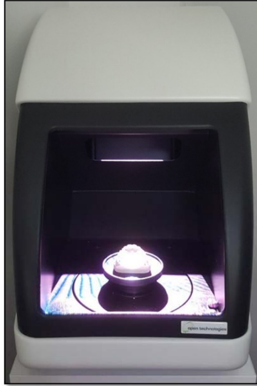
Şekil 3.1. Aurum LT 3D yüzey tarama cihazı
