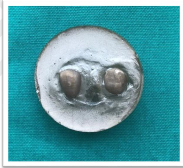
Şekil 3.16: Au-Pd-Platin kaplanmış SEM örneği.
