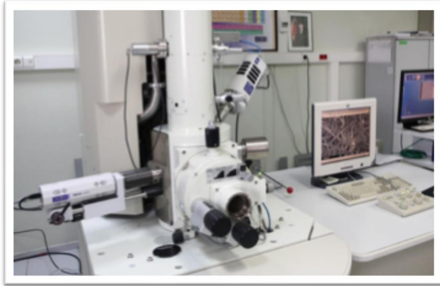
Şekil 3.14: Taramalı Elektron Mikroskobu (SEM) cihazı.
