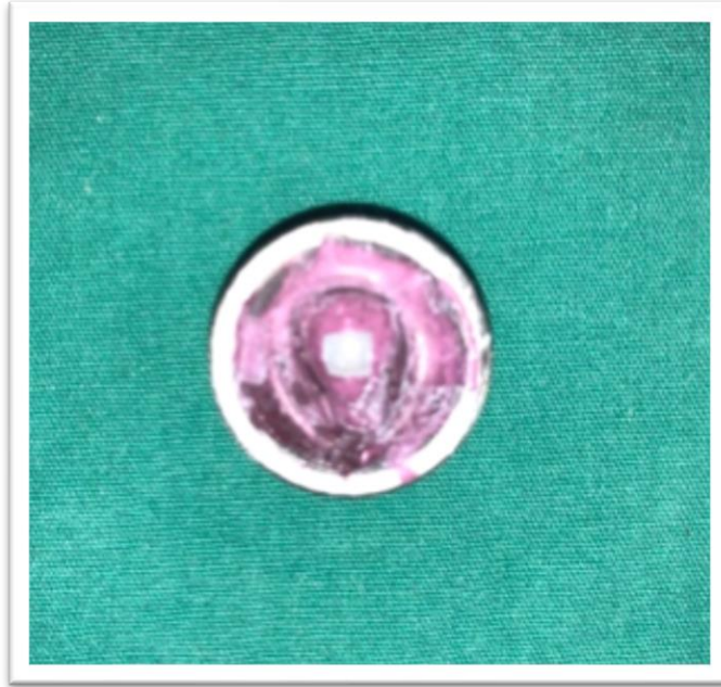
Şekil 3.3: Dişlerin metal bloklara gömülmesi ve aside dirençli cilanın uygulanması.
