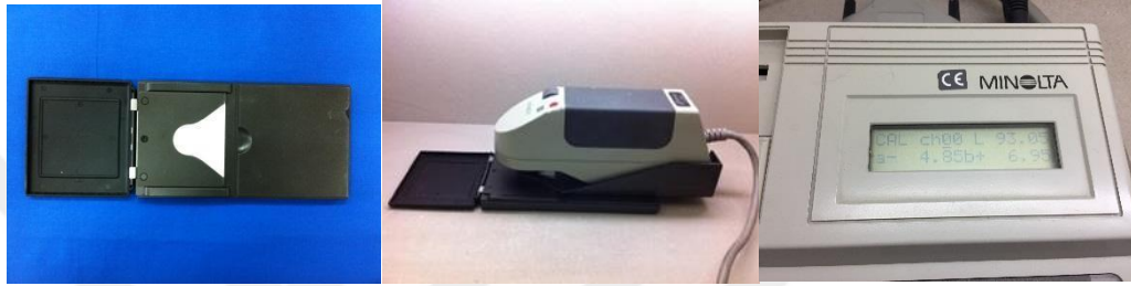
řekil 3.27: Kalibrasyon Plađı ve Kalibrasyon İřlemi
