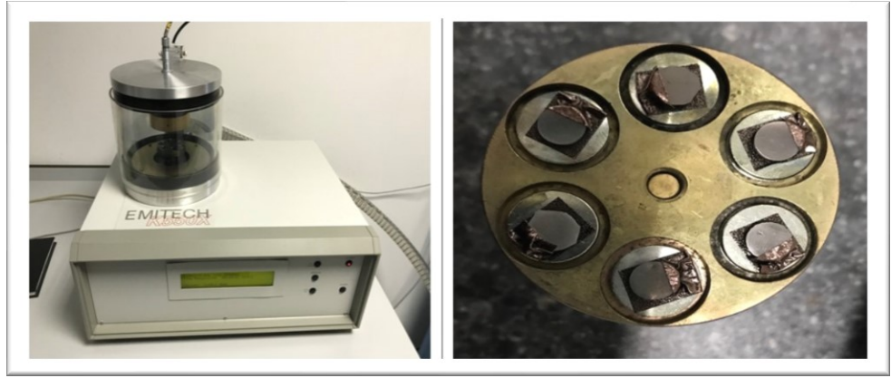
Şekil 3. 20: Örnek SEM analizi için altın kaplanması
