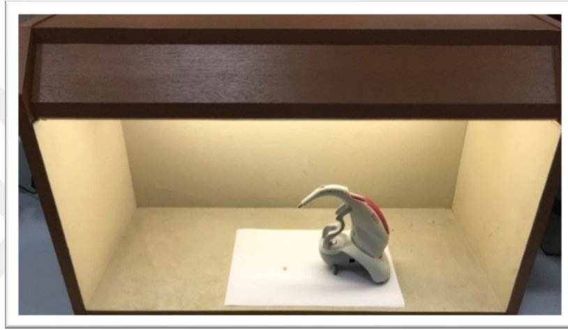
Şekil 3. 19: Renk ölçüm düzeneği
