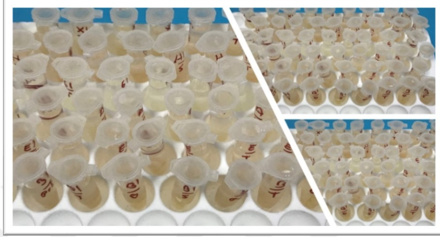
Şekil 3. 15: Örneklerin 24 saat suda beklemesi
