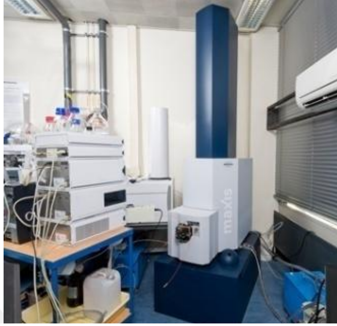
Şekil 2. 3. İlk ticari elektrosprey kütle spektrometresi.
