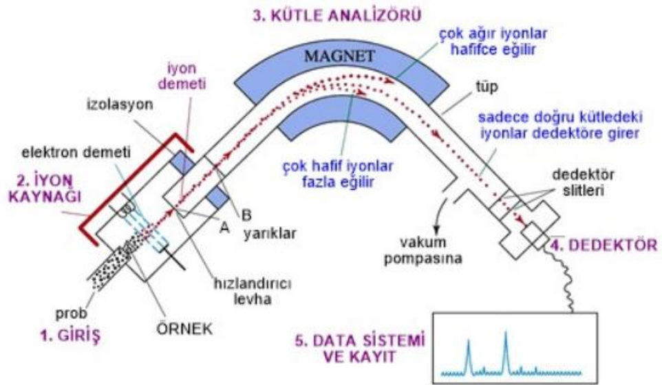
Şekil 2. 5. Manyetik sektörlü kütle spektrometresinin kısımları.
