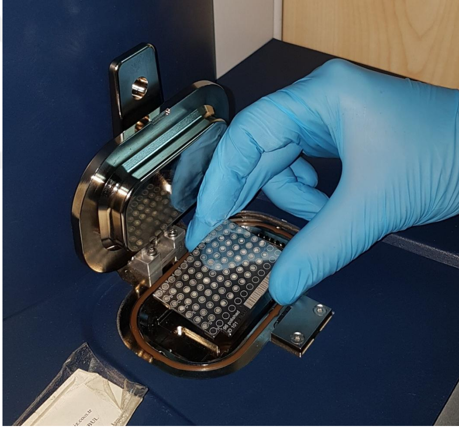
Şekil 3. 16. MSP 96 Targetin MALDI-TOF MS sistemi haznesine yerleştirilmesi
