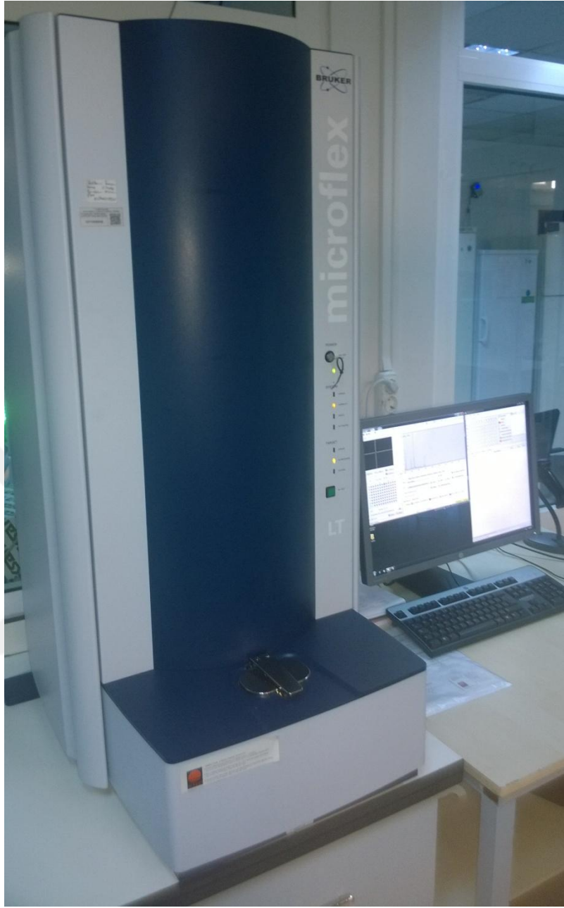
Şekil 3. 17. MALDI-TOF-MS (Bruker Daltonics Microflex LT) sistemi ve MALDI Biotyper 3.1 yazılımı (Bruker Daltonics, Bremen, Germany)
