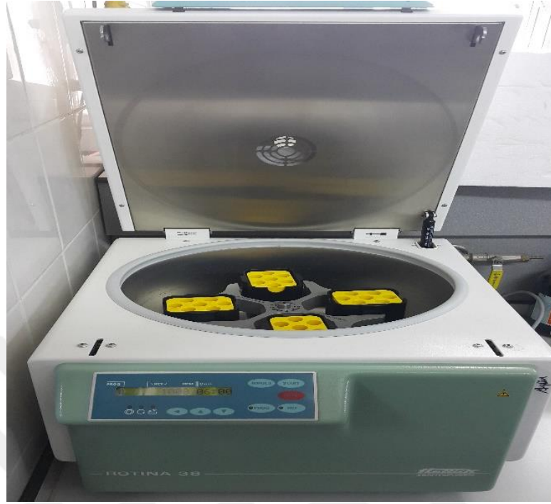
Şekil 3. 8 Santrifuj cihazı(Hettrich Rotina 90, Almanya)
