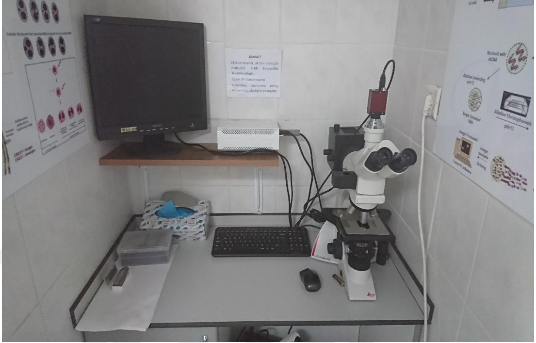
Şekil 3. 12 Floresan mikroskop(Leica PM 1000, Almanya)
