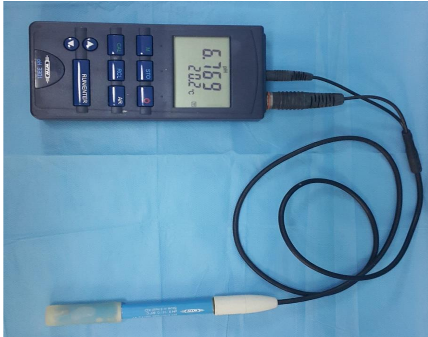
Şekil 3. 9 pH metre cihazı(WTW pH 330i, Almanya)
