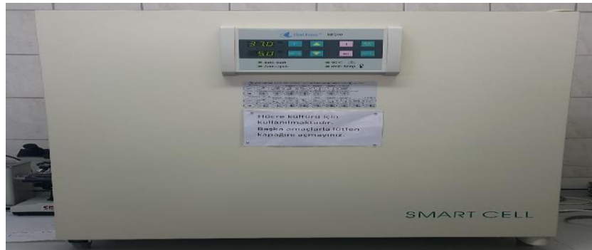
Şekil 3. 7 Karbondioksit inkübatörü(Heal Force HF240, Çin)
