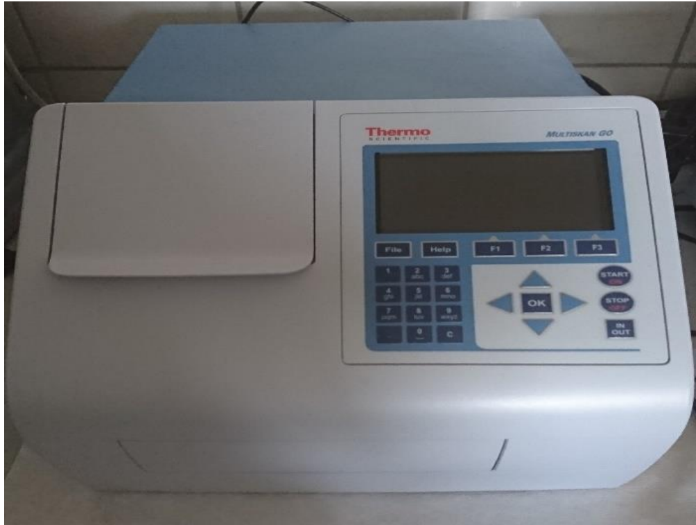
Şekil 3. 13 Multiplaka okuyucu(Thermo Scientific Mutiskan Co., Finlandiya)
