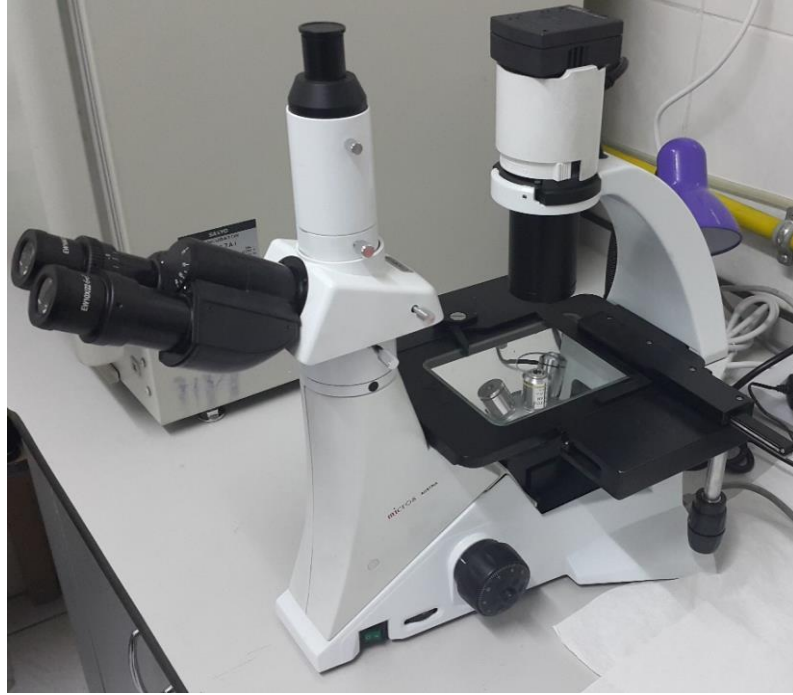
Şekil 3. 11 İnvrted Mikroskop(Micros MCX 7600,Avusturya)
