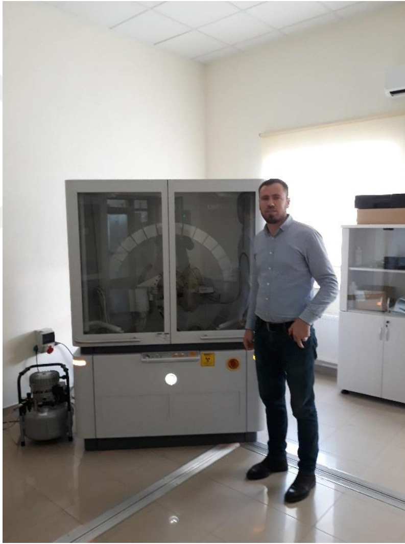
Foto 3. 14. XRD (X-Iřını Difraktometresi)
