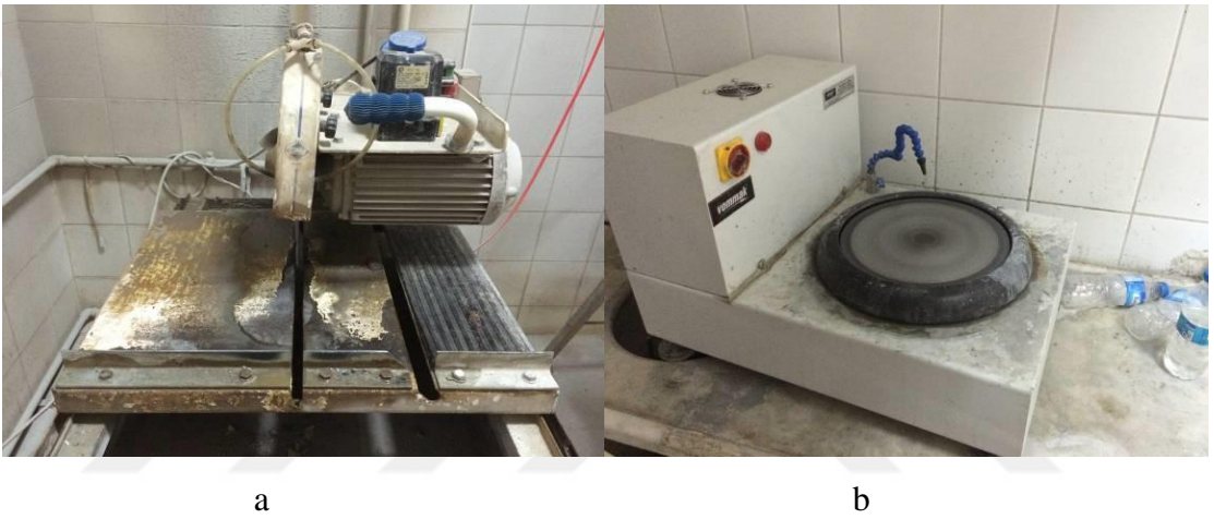
Foto 3. 9. Kayaç kesme makinesi (a) ve ince kesit makinesi (b).
