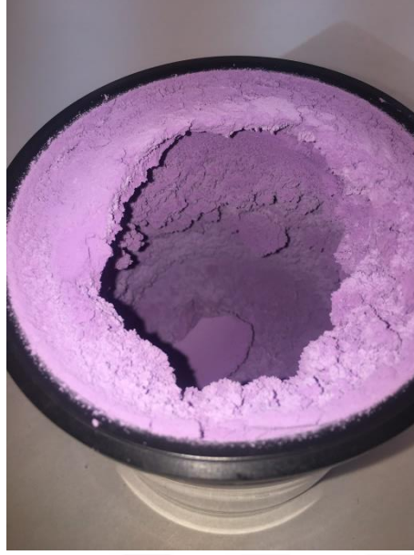
Fotoğraf 4.2. Enkapsüle edilmiş (SM) örneğin kurutulması sonunda püskürtmeli kurutucu haznesi
