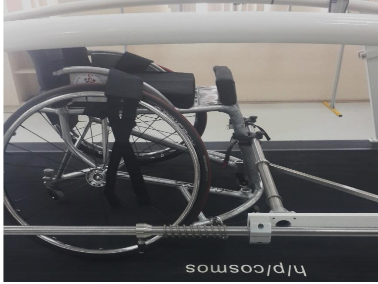
Şekil 3.8. TS'lerin koşu bandına sabitlenmesi için kullanılan aparat.
