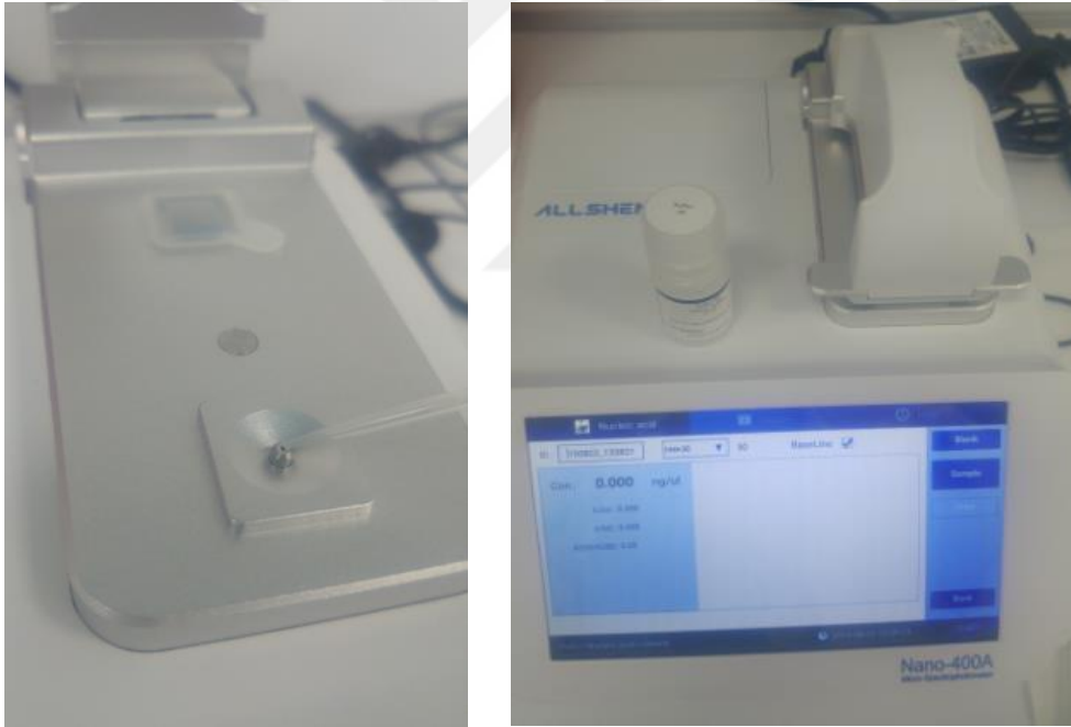
Şekil 9. Nano spektrofotometre cihazına referans örnek konulması ve cihazın sıfırlanması
