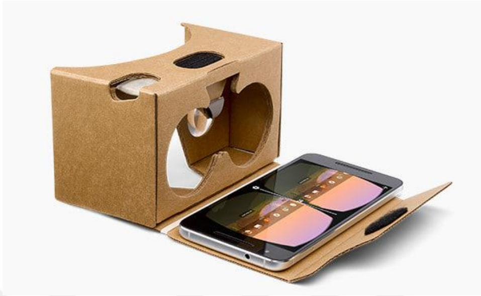
Şekil 5. Google Cardboard platformunun tam anlamıyla deneyimlenebildiği karton ve merceklerle oluşturulmuş bir mobil sanal gerçeklik kurulumu (Google, 2017a)
