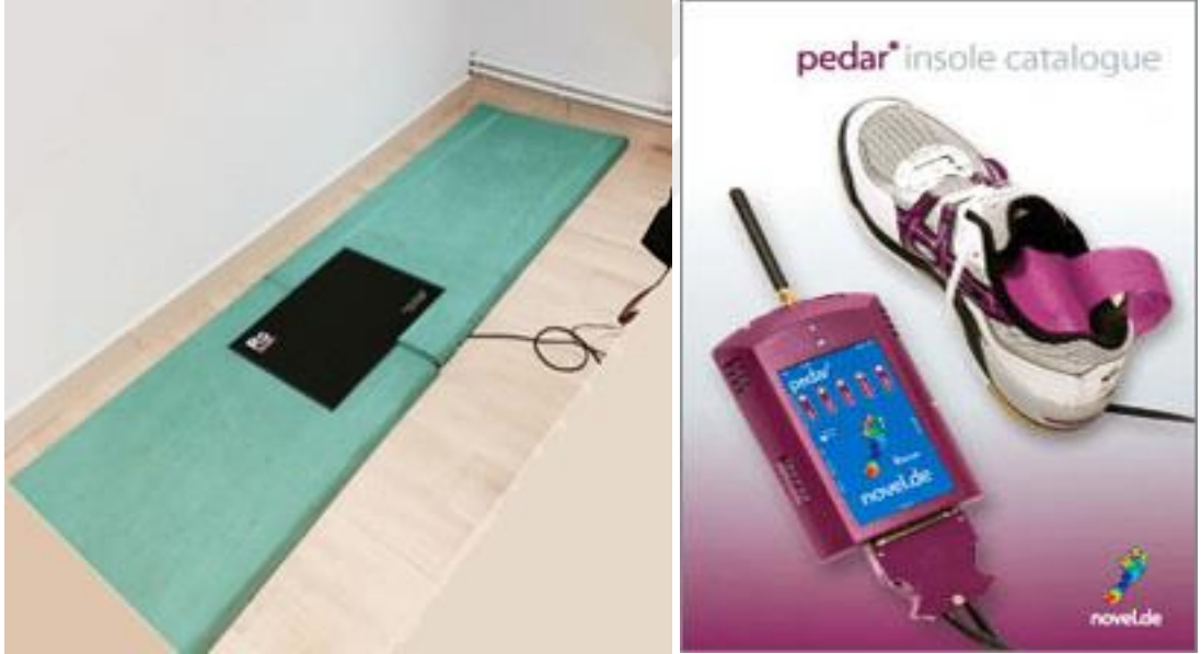
Resim 1: Platform şeklindeki ve ayakkabı içerisine giyilebilen pedobarografi cihazları.
