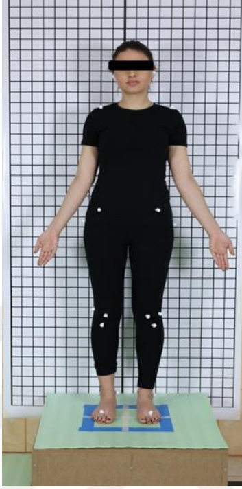
Resim 12: Beyaz polistiren küreler ile işaretlenen antropometrik noktalar.
