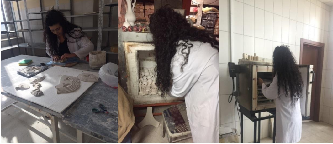
Şekil 56. Elde Şekillendirme Formları, Bisküvi Pişirimi
