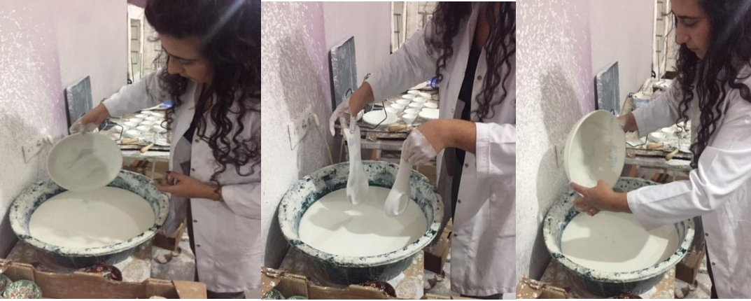
Şekil 61. Pişirimi Yapılmış Dekorlu Formların Sırlama İşlemi
