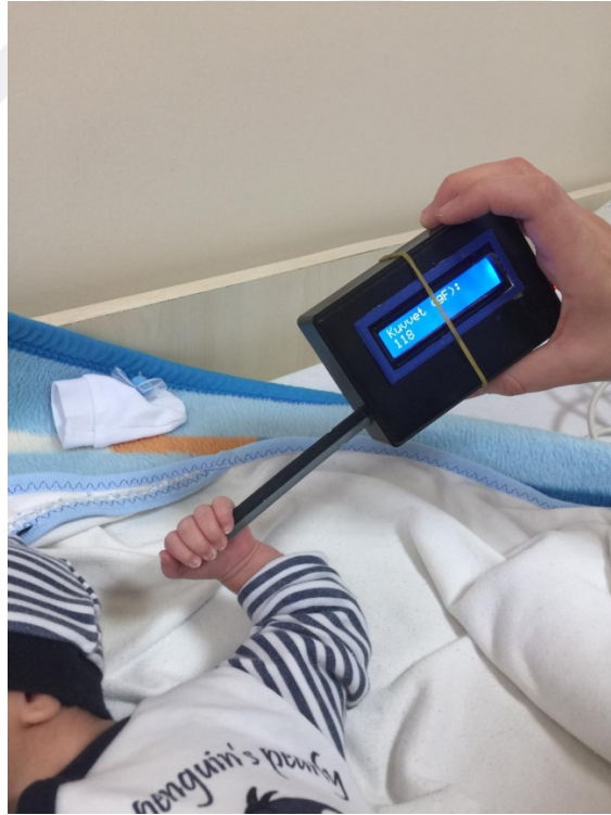
Resim:1 Kavrama Refleksi Kuvveti Ölçümü
