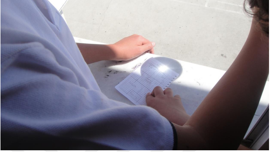
İnce Kenarlı Merceğin Işığı Topladığını Test Etme Deneyi
