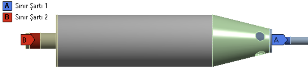
Şekil 3.25. Tambur için Uygulanan Modal Analizin Sınır Şartları
