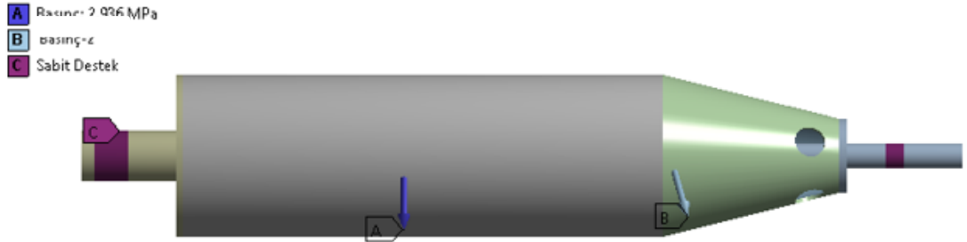
Şekil 3.16. Dekantöre Basınç Yüklemesi ve Sınır Koşulu
