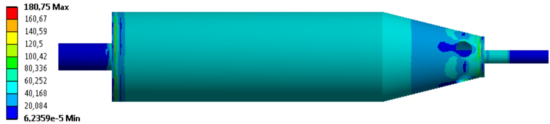
Şekil 4.1. Dekantörün Eşdeğer Gerilmesi [MPa]
