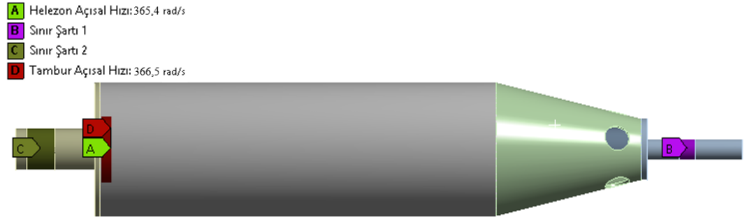
Şekil 3.24. Dekantörün Açısal Hız Etkisi için Yükleme ve Sınır Şartları
