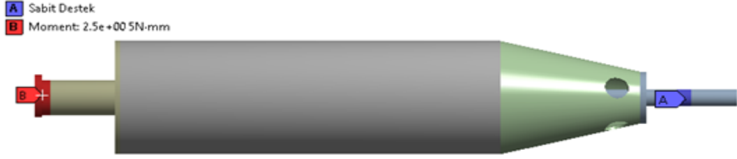
Şekil 3.18. Dekantöre Tork Yükleme ve Sınır Koşulu
