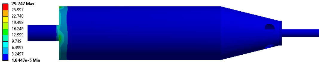
Şekil 4.12. Tamburda Açısal Hızın Etkisi – Eşdeğer Gerilme [MPa]
