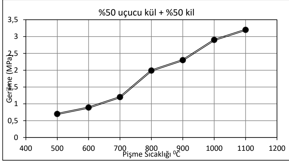
Şekil 4.28. Farklı sıcaklıklarda pişen tuğlaların pişme sıcaklığı-gerilme davranışı
