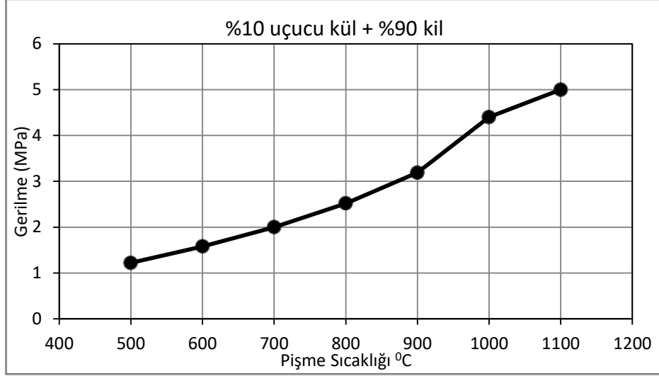
Şekil 4.24. Farklı sıcaklıklarda pişen tuğlaların pişme sıcaklığı-gerilme davranışı
