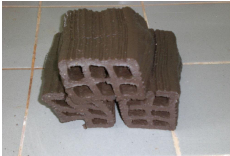
Şekil 4.31. 1200 C 0 de pişmiş tuğla numuneleri
