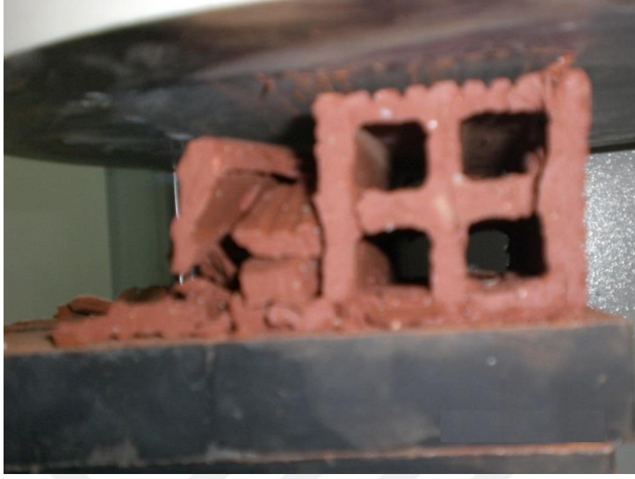
Şekil 4.34. Beton test basıncında kırılmış tuğla numunesi
