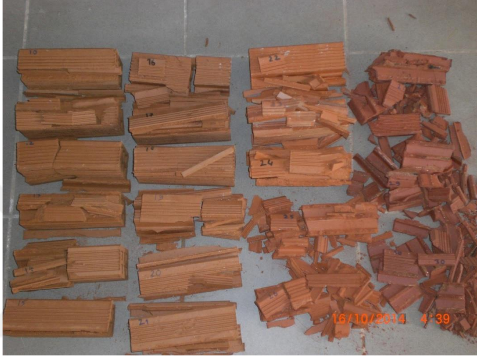
Şekil 4.36. Farklı sıcaklıklarda pişen tuğlaların basınç dayanımından sonraki görüntüleri (soldan sağa ve yukarıdan aşağıya pişme sıcaklığı artmaktadır)
