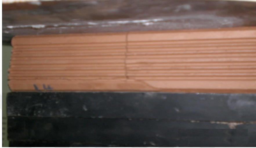
Şekil 4.32. Beton test basıncında kırılmış tuğla numunesi
