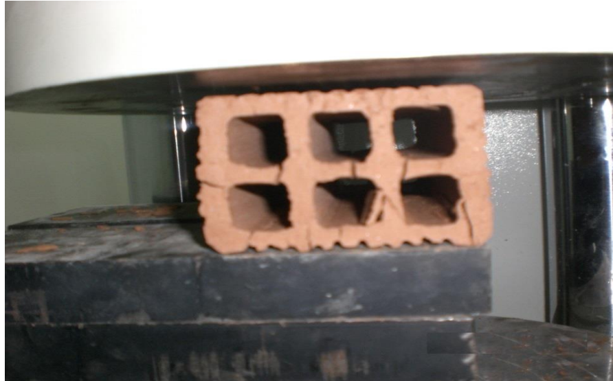
Şekil 4.33. Beton test basıncında kırılmış tuğla numunesi
