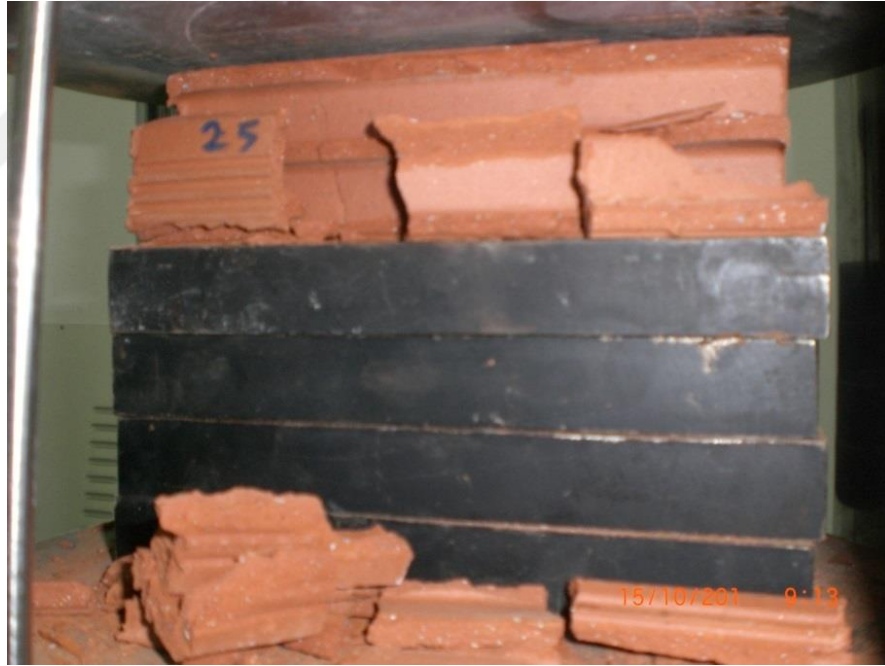
Şekil 4.35. Beton test basıncında kırılmış tuğla numunesi
