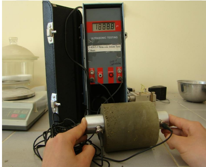
Şekil 3.14. Standart proktor numunesinin ultrasonik hız ölçümü
