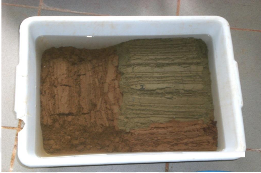
Şekil 4.30. 500 c 0 de pişmiş tuğla numuneleri
