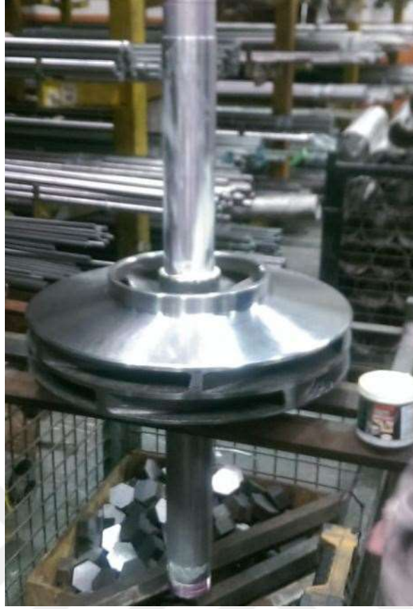
Şekil 7.10. Pompa çarkı ile milinin boşluklu geçme kontrolü
