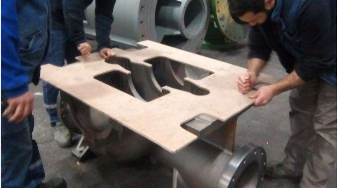
Şekil 7.7. Ayırma yüzeyinin oluşturulan masterla kontrol edilmesi
