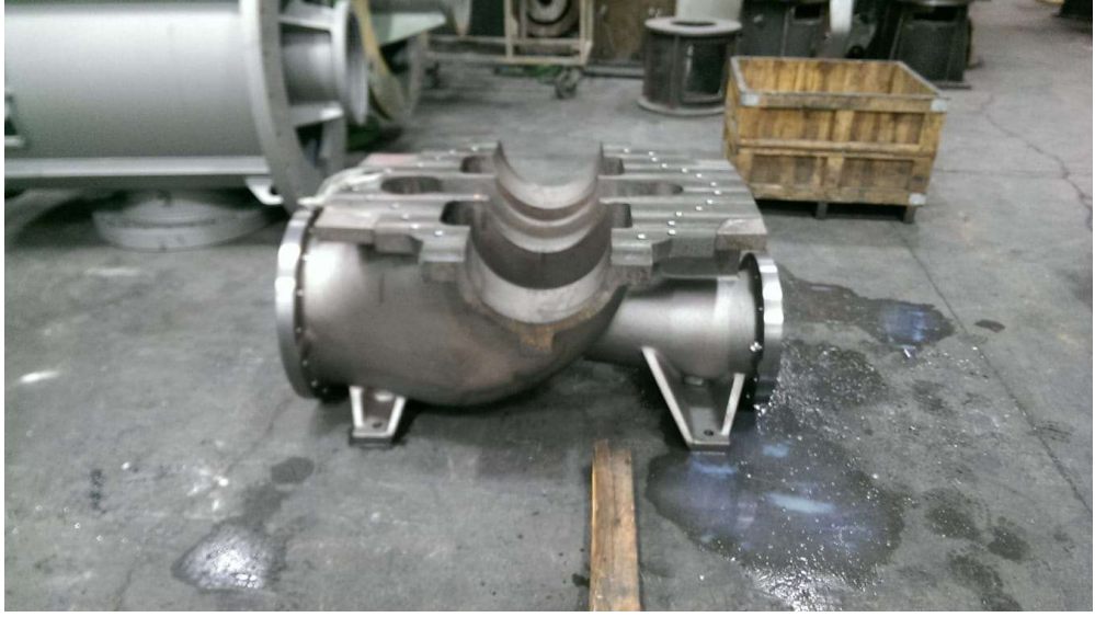
Şekil 7.8. Dik işleme merkezinden çıkmış alt gövde ayırma yüzenin işlenmiş resmi
