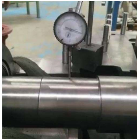
Şekil 7.11. Mekanik salmastranın bulunduğu noktalarda salgı kontrolü
