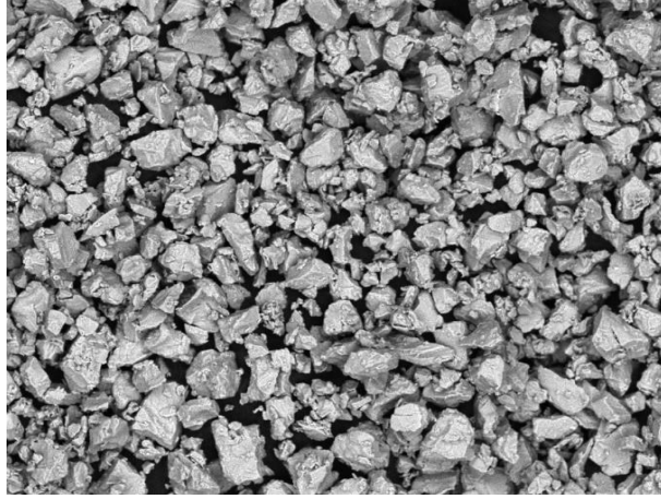
Şekil 6.2. PEEK numunelerin kaplanmasında kullanılan Ti tozlarının morfolojisi (-106 +45 \mu\text{m} )
