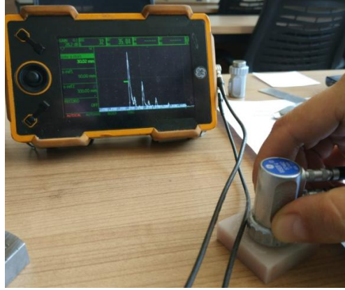
Şekil 4.9. Ultrason ses dalgası testi.
