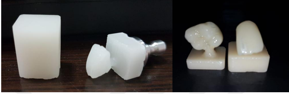
Şekil 5.25. A frit ve B frit ile işlenmiş santral ve azı diş görüntüleri.
