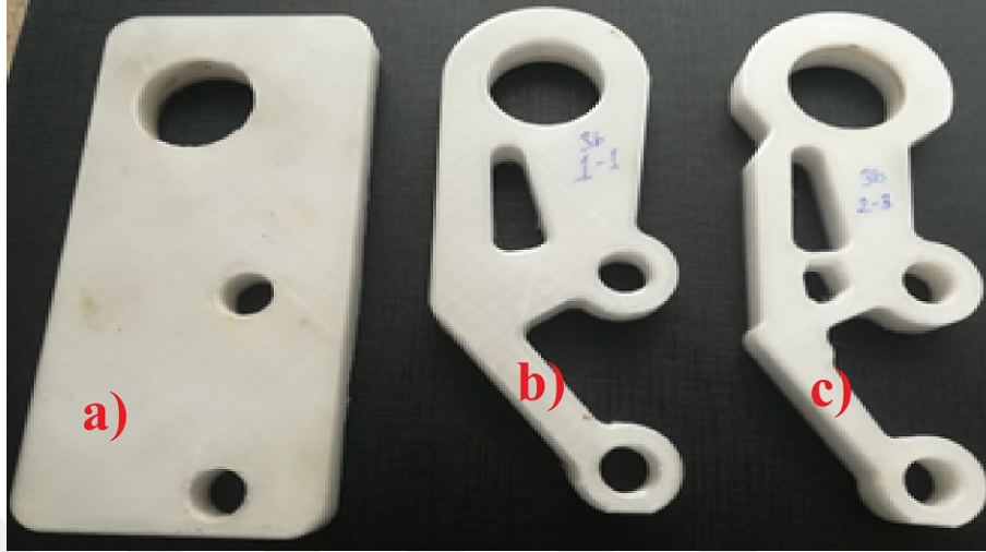
Şekil 4.22. 3B yazıcı ile üretilen parçalar a) Kavramsal model, b) İlk optimizasyon, c) ikinci optimizasyon.
