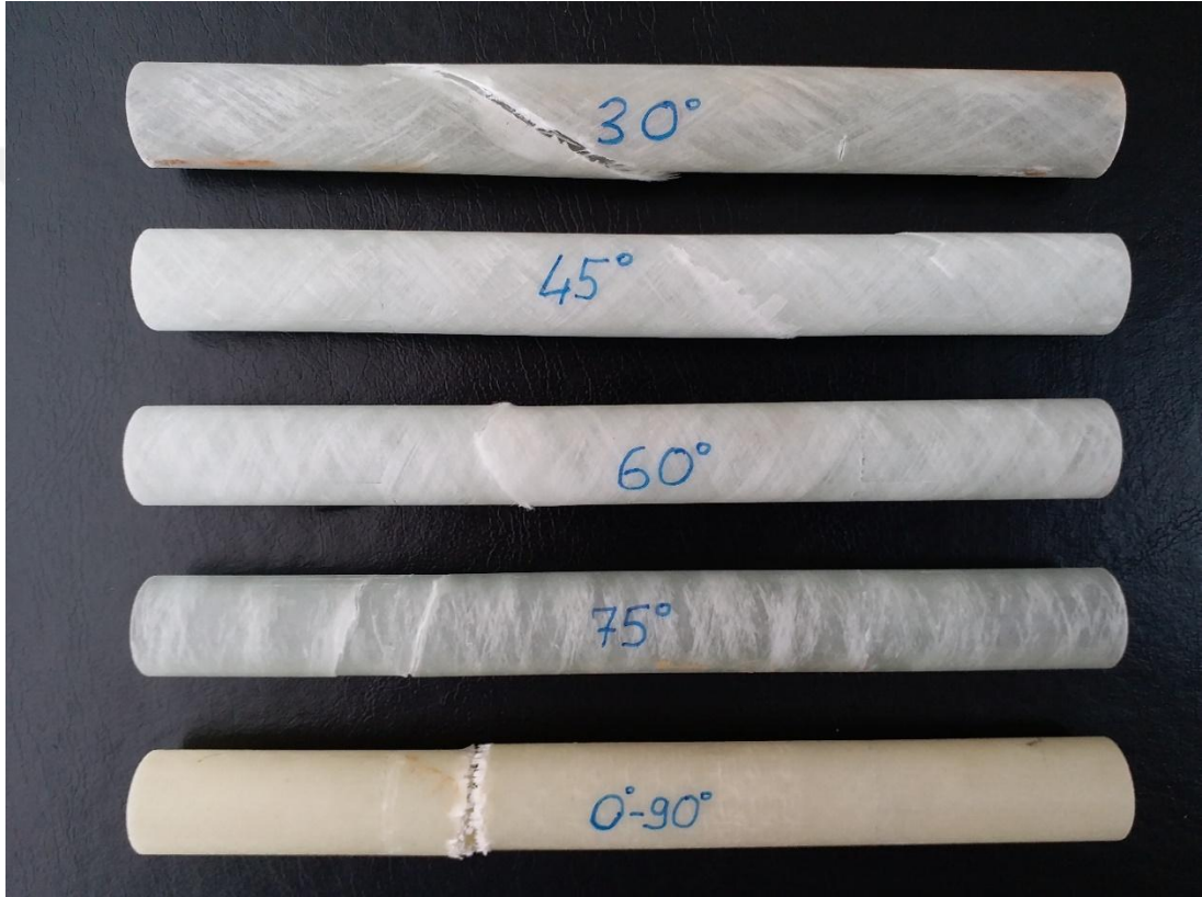
Şekil 4.10. Çeşitli tipteki numunelerin burulma hasarı meydana geldikten sonraki son görünümleri ve hasar modları
