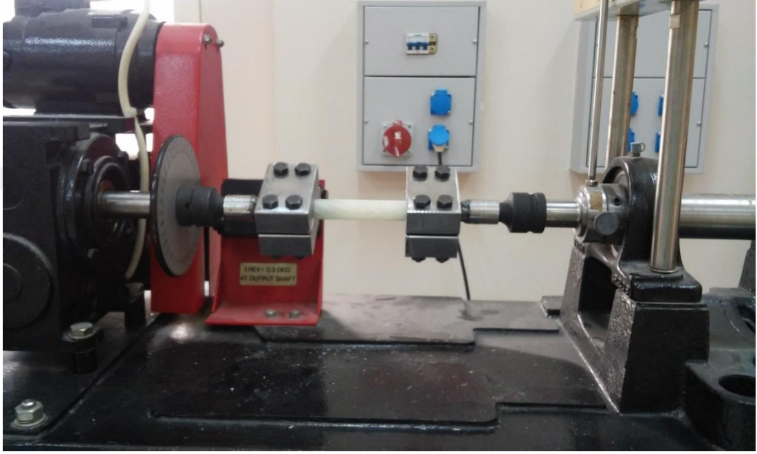
Şekil 3.4. Burulma test cihazı ve numunenin özel bir aparat ile makineye monte edilmesi
