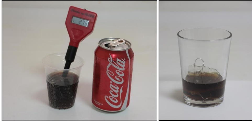
Resim 4. Demineralizasyon uygulamasından önce dijital bir pH metre kullanılarak solüsyonun (Coca Cola, The Coca Cola company, Ankara, Türkiye) pH'sının ölçülmesi ve apareyin solüsyonda bekletilmesi.
