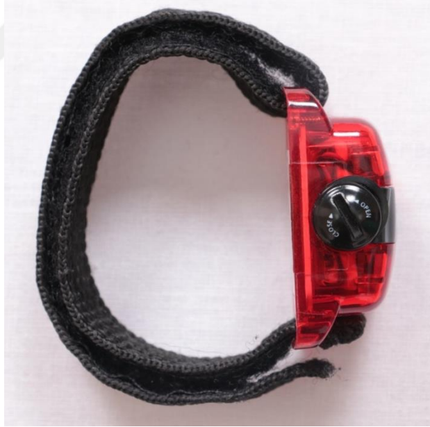
Resim 5. USB kablosunun giriş yerini koruyan anahtar ile açılıp kapatılabilen kapak ve cihazın yandan görünüşü
