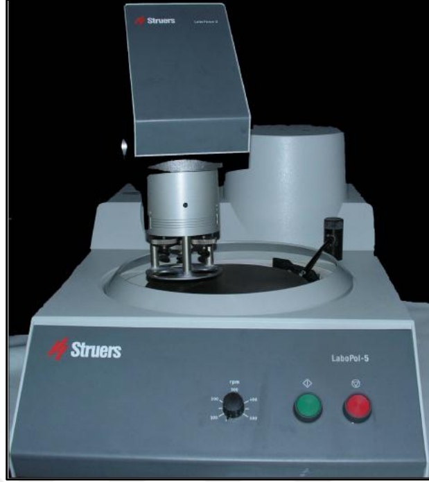
Resim 3. Metalografik polisaj cihazı (Labopol 5, Struers, Danimarka)
