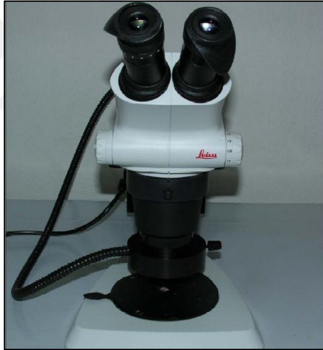
Resim 4. Stereomikroskop (S4E, Leica Microsystems, Almanya)
