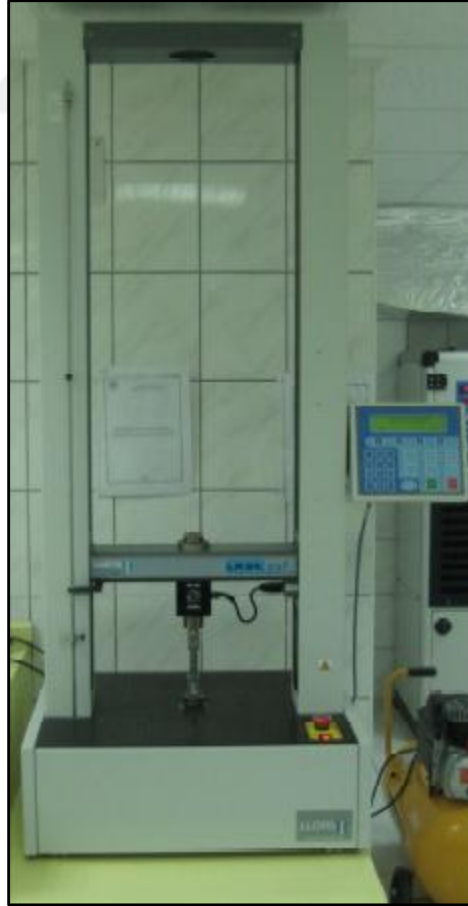
Resim 7. Mikrogerilme bağlanma dayanımı test cihazı (LR 5K Lloyd, İngiltere)
