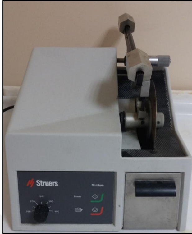
Resim 2. Hassas kesme cihazı ve elmas kesme diski(Minitom, Struers, Danimarka)
