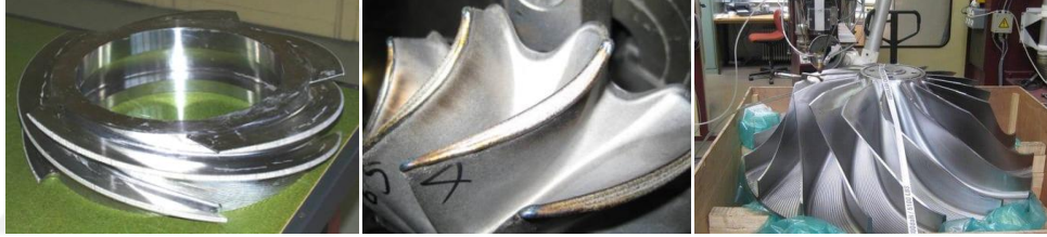
Şekil 2.10. Lazer kaplama yapılmış örnek uygulamalar [17].
