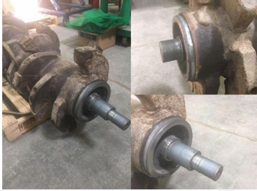
Şekil 2.9. Lazer kaplama yapılmış örnek uygulamalar [16].
