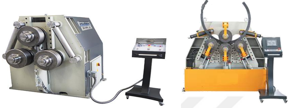
Şekil 2.23 a) Üç toplu profil bükme makinesi b) Dört toplu profil bükme makinesi
