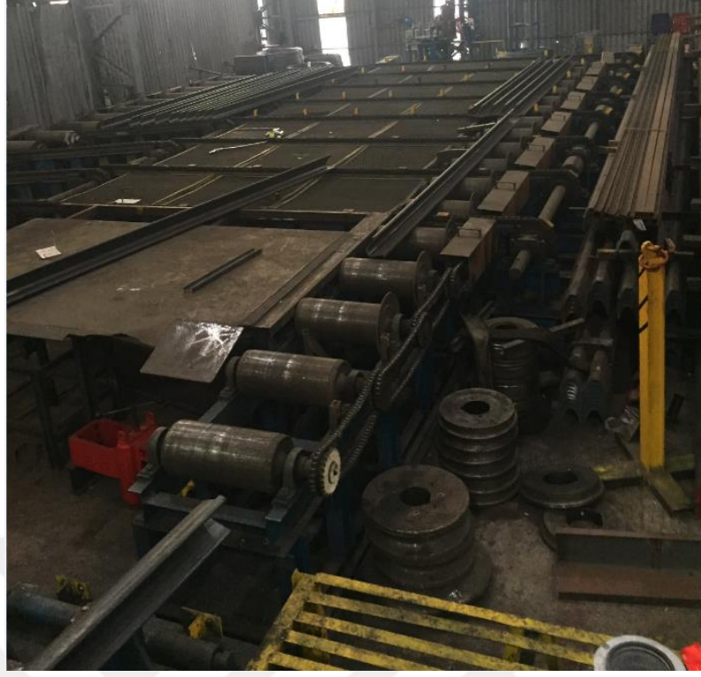
Şekil 3.25. Prototip bükme uygulamalarında kullanılan boy kesim işlemi tamamlanmış iş parçaları
