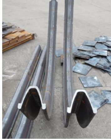
Şekil 3.28. Prototip bükme işlemi sonrasında elde eden ilk ürünler
