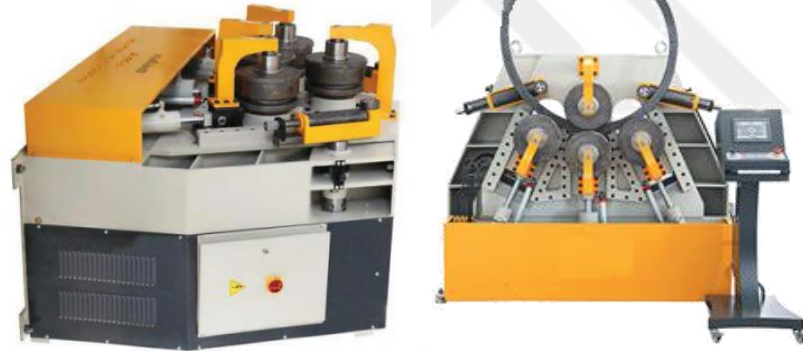
Şekil 2.24 a) Yatay pozisyonlu profil bükme makinesi b) Dikey pozisyonlu profil bükme makinesi
