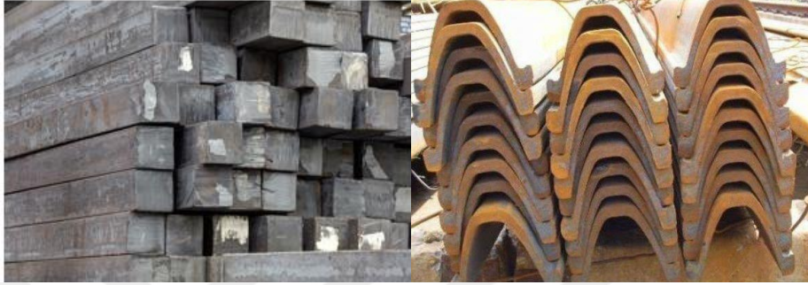
Şekil 3.1. Profil üretiminin hammaddesi olan kütük ve üretilen TH profil
