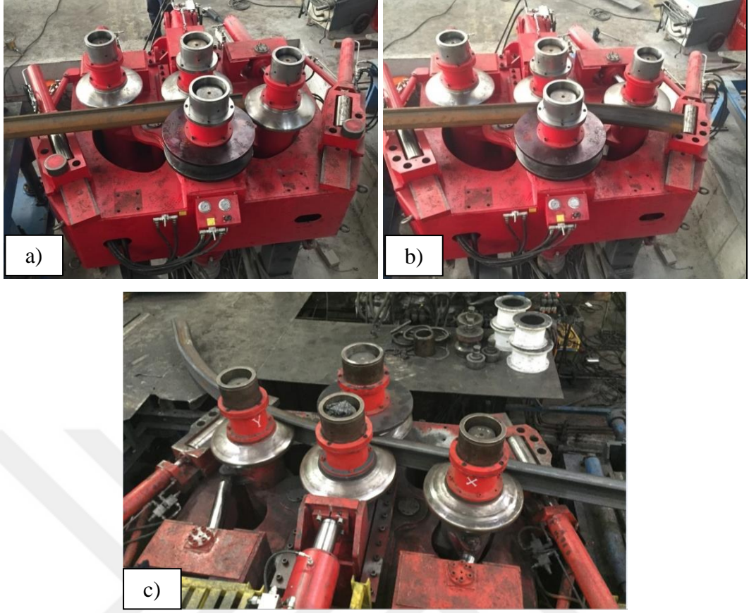
Şekil 3.27. Prototip bükme uygulaması aşaması; a) İş parçasının sıfır konumuna getirilmesi b) Bükme işlemi başlangıcı c) Radyüs oluşturma aşaması
