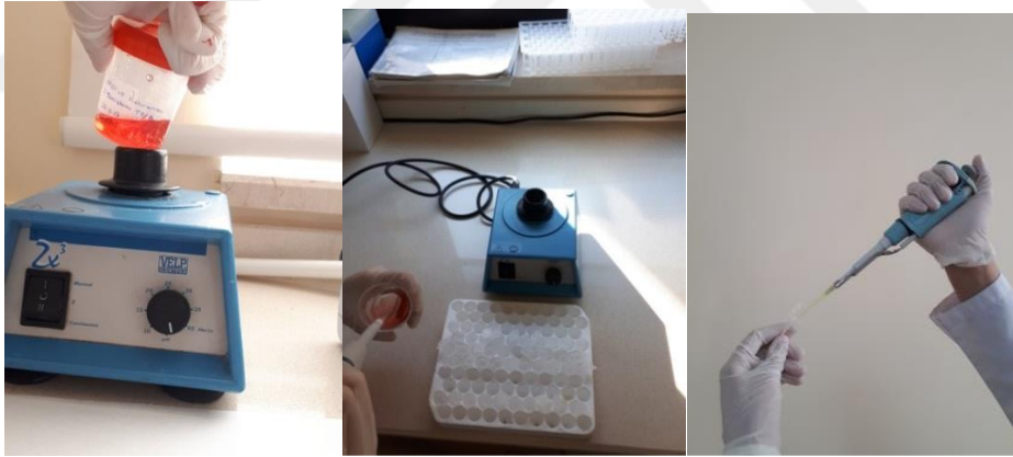
Resim 16. TPPA örneğinin de içinde bulunduğu %0,25 Trypsin-EDTA çözeltisinin vorteks karıştırıcıda homojenizasyonu ve çalışılmak üzere 1ml' sinin alınması.
