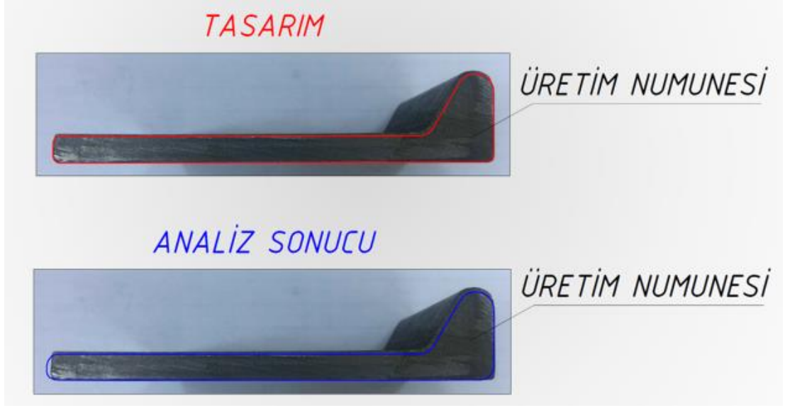
Şekil 4.32 Tasarım, simülasyon ve üretim sonuçları kıyaslaması
