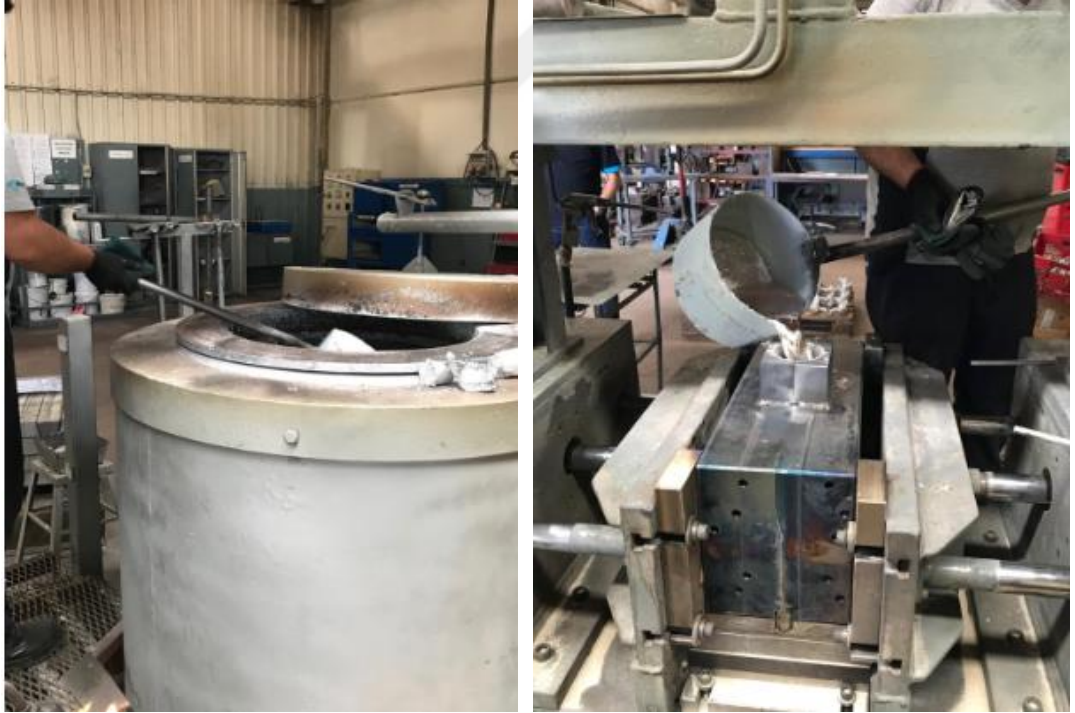
Şekil 3.2. Kokil Döküm Prosesi
