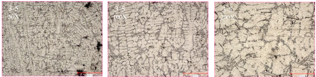
Şekil 4.44. 3-5 Numaralı numune grubuna ait mikroyapı görüntüleri
