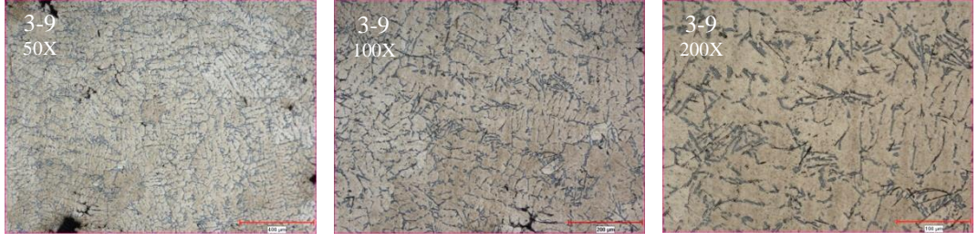
Şekil 4.56. 3-9 Numaralı numune grubuna ait mikroyapı görüntüleri
