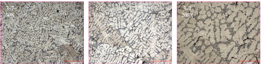
Şekil 4.50. 3-7 Numaralı numune grubuna ait mikroyapı görüntüleri
