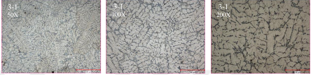
Şekil 4.32. 3-1 Numaralı numune grubuna ait mikroyapı görüntüleri
