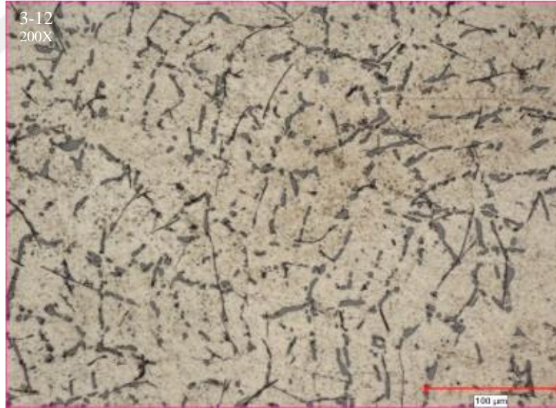
Şekil 4.77. 3-12 nolu numunenin 200X büyütme ile çekilmiş mikroyapı görüntüsü
