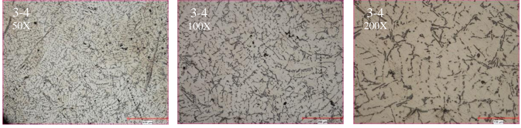
Şekil 4.41. 3-4 Numaralı numune grubuna ait mikroyapı görüntüleri
