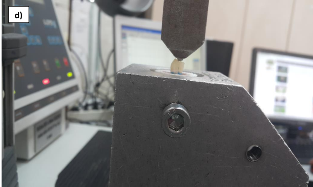
Resim 18. a) Dişlerin akrilik rezine gömüldükten sonraki görüntüsü b) Tüm örneklerin hazırlanmış hali c) Kıırma testi için kullanılan Universal test cihazı d) Universal test cihazında basma dayanımı ölçmek için hazırlanan düzenek.
