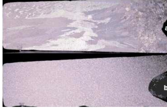
Şekil 2.5 a) Tane inceltilmemiş, (b) Al_5Ti_1B mastır alaşımı ilaveli alüminyum alaşımının tane yapıları [11]
