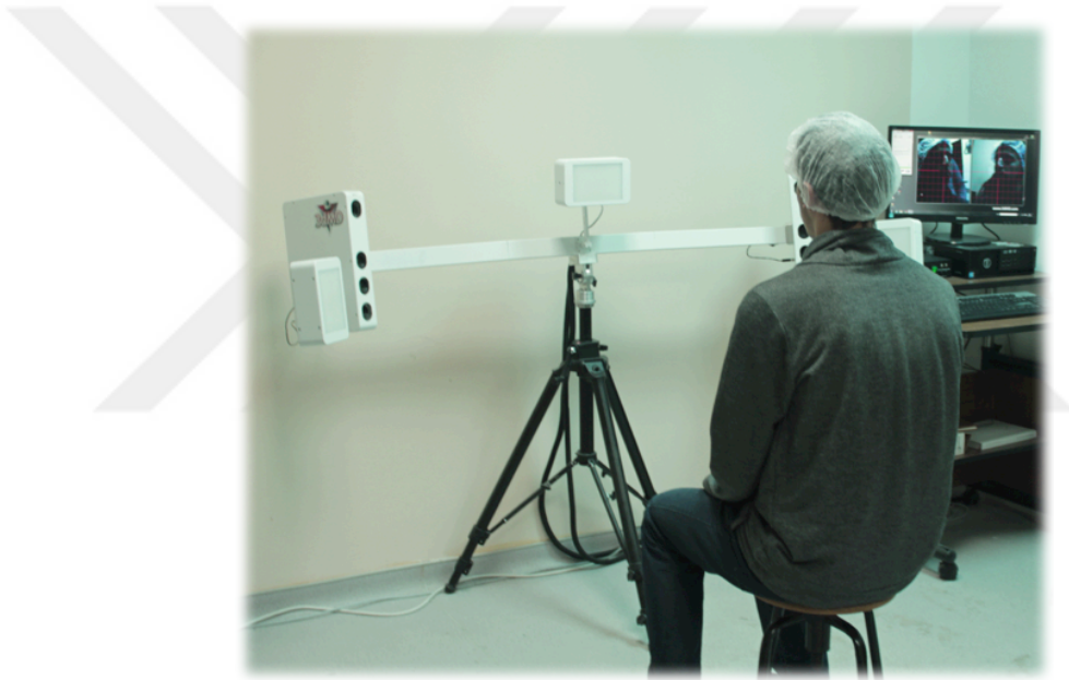
Resim 1. 3dMD görüntüleme sistemi ve kameraların pozisyonlandırılması ile stereofotogrametri kayıtlarının alınması
