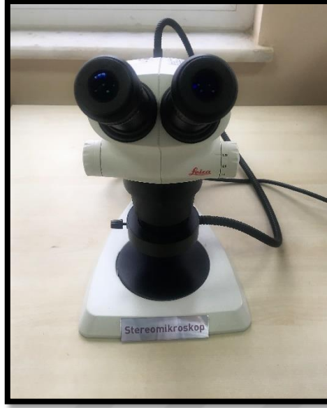
Resim 14. Çalışmamızda kullanılan stereomikroskop (S4E, Leica Microsystems, Almanya).
