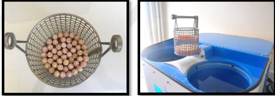
Resim 12. Örneklerin termal siklus cihazına yerleştirilmesi
