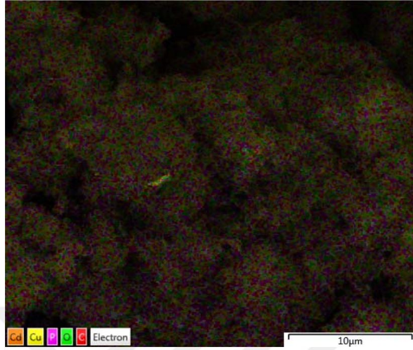
Şekil 4.46. 800 mg/L Cd 2+ iyonları adsorplamış HNF SEM-EDX(EDS) görüntüsü
