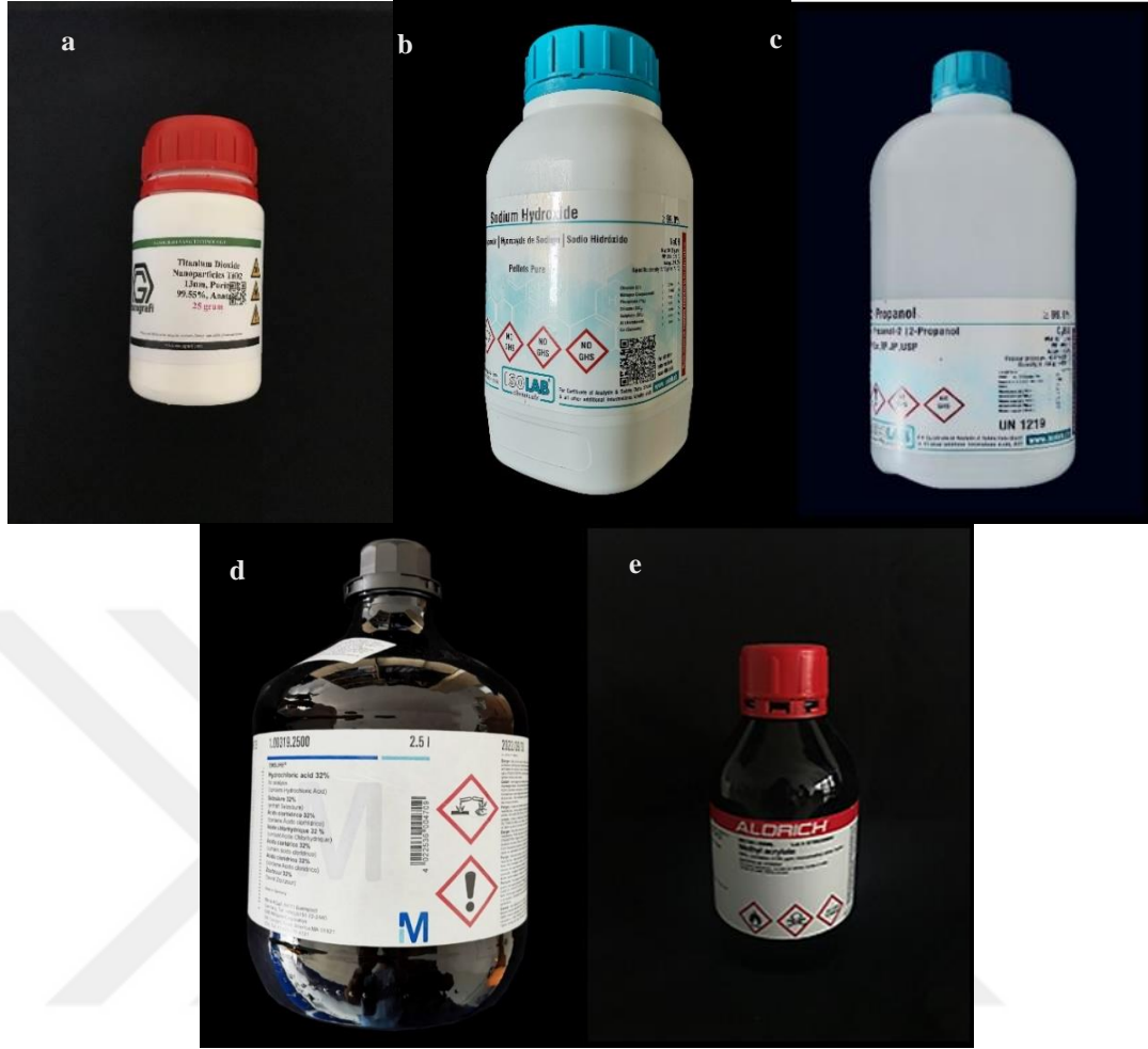
Resim 4. Çalışmada kullanılan laboratuvar malzemeleri a) Titanyum dioksit ( \text{TiO}_2 ) tozu b) Sodyum hidroksit (NaOH) c) 2-propanol d) Hidroklorik asit (HCl) e) Metakrilik asit
