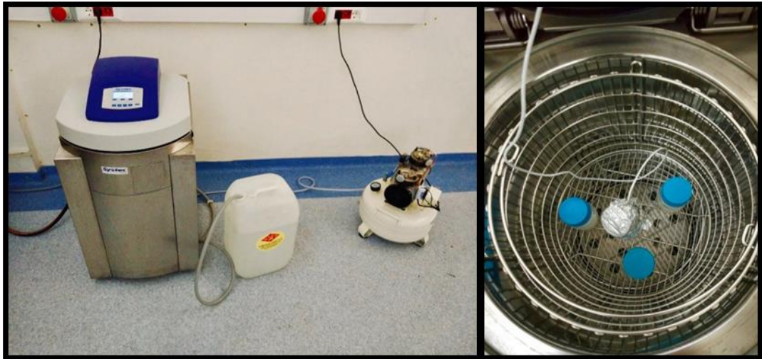
Resim 6. Otomatik su beslemeli yüksek basınç buhar sterilizatörü
