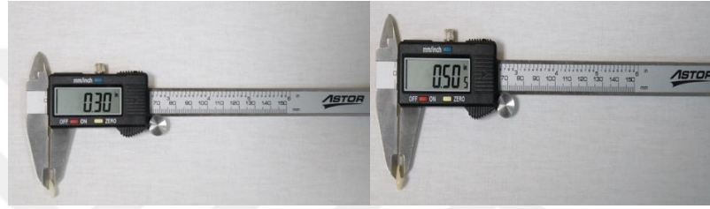
Resim 4. Restorasyon kalınlıklarının dijital kumpasla ölçülmesi
